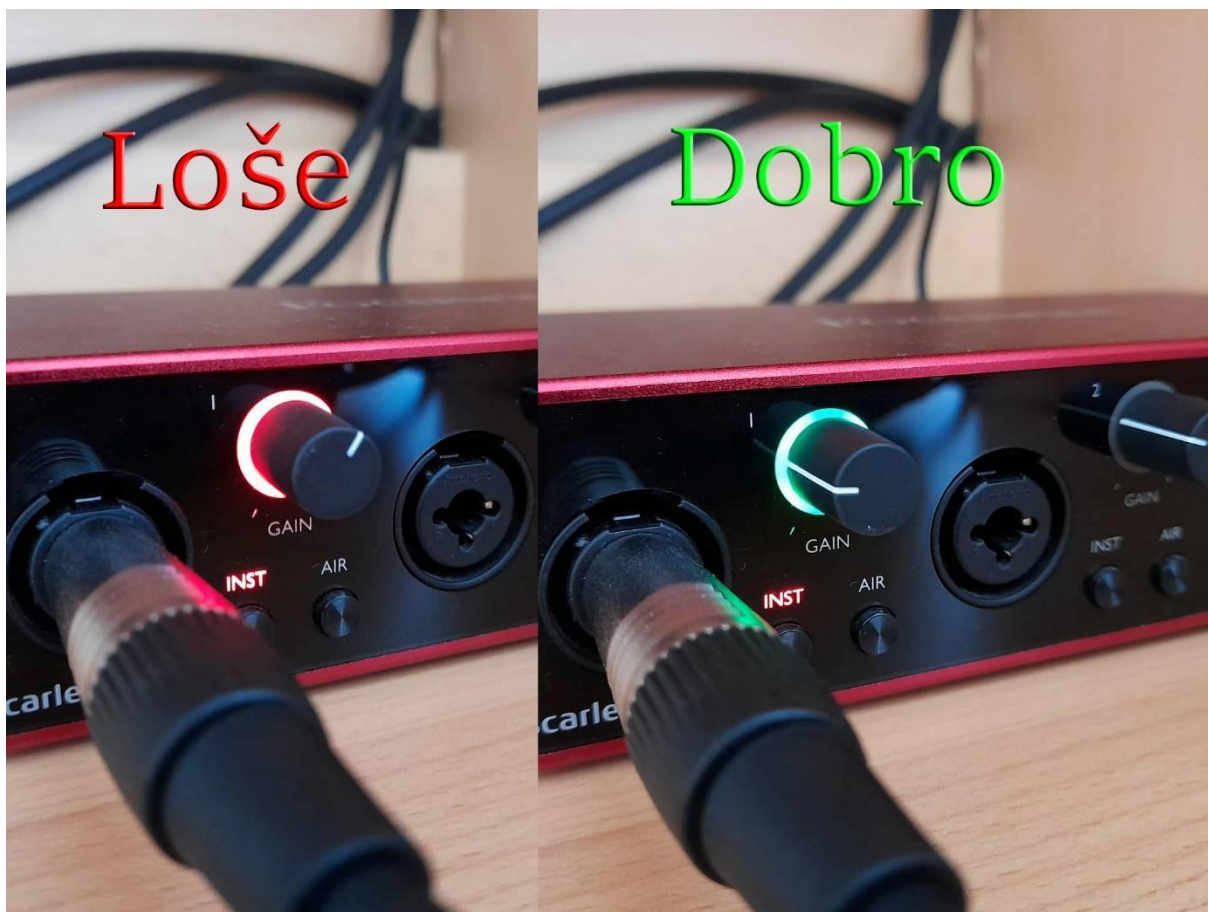
Slika 5.1.2. Prikaz signala koji clippa
