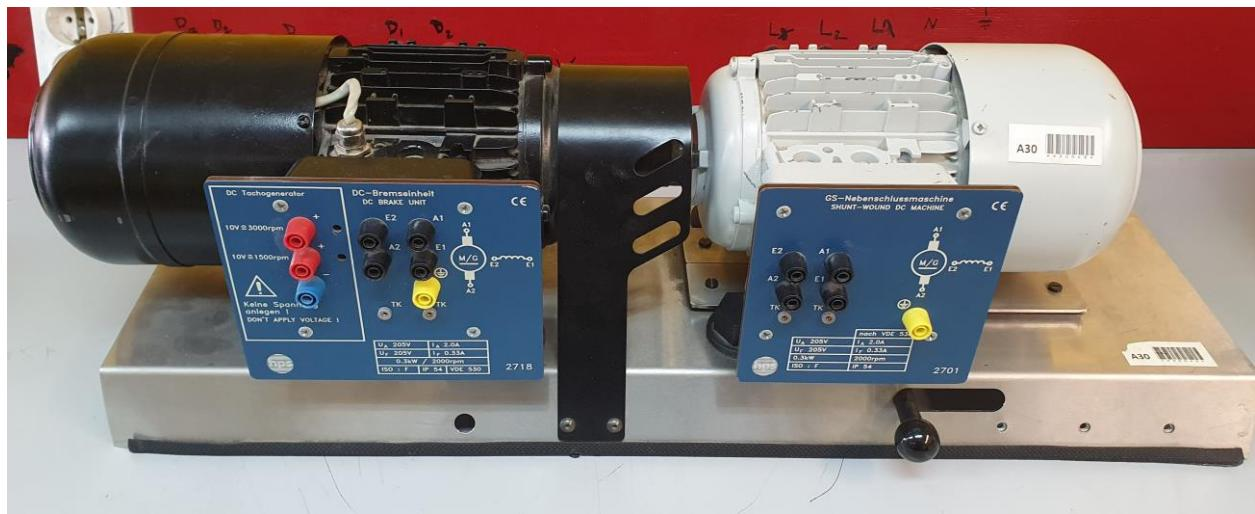
Slika 1.2. Slika istosmjernog motora iz laboratorija
