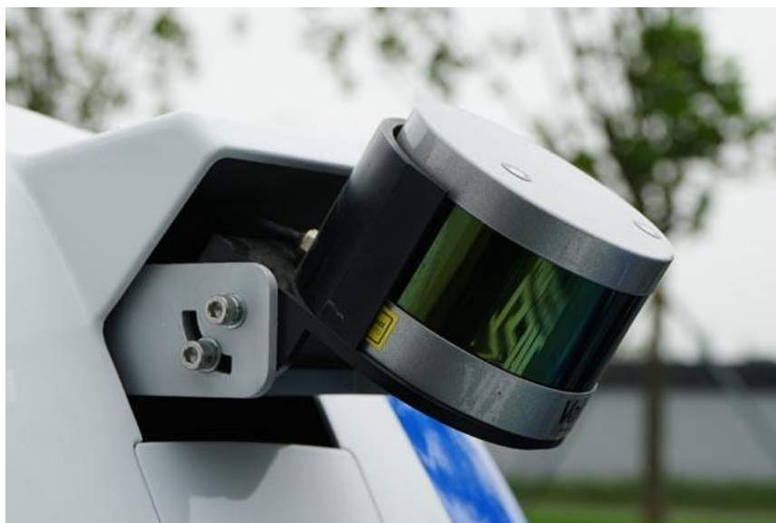
Slika 3.4 LIDAR s višestrukim zrakama svjetlosti [9]
