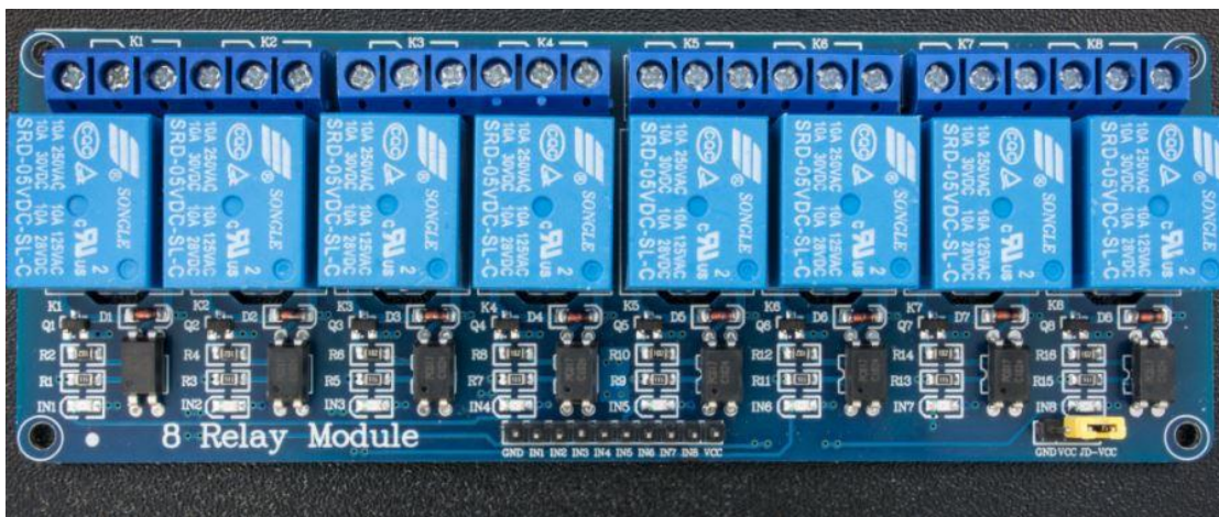
Slika 4.11 Relejni modul s 8 releja
