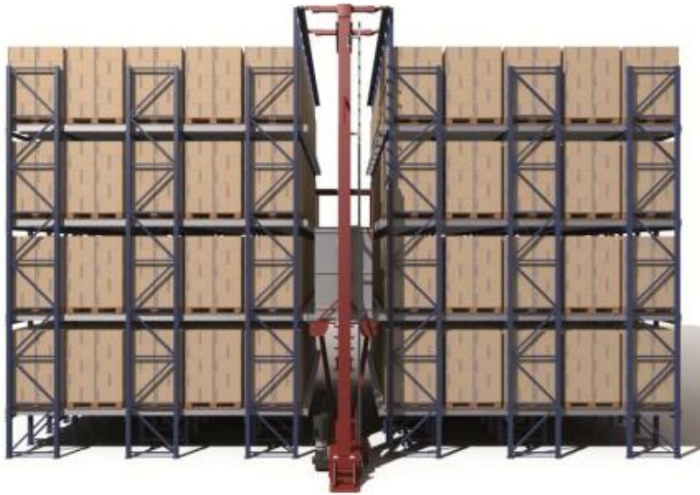
Slika 17. Multiple deep AS/RS
