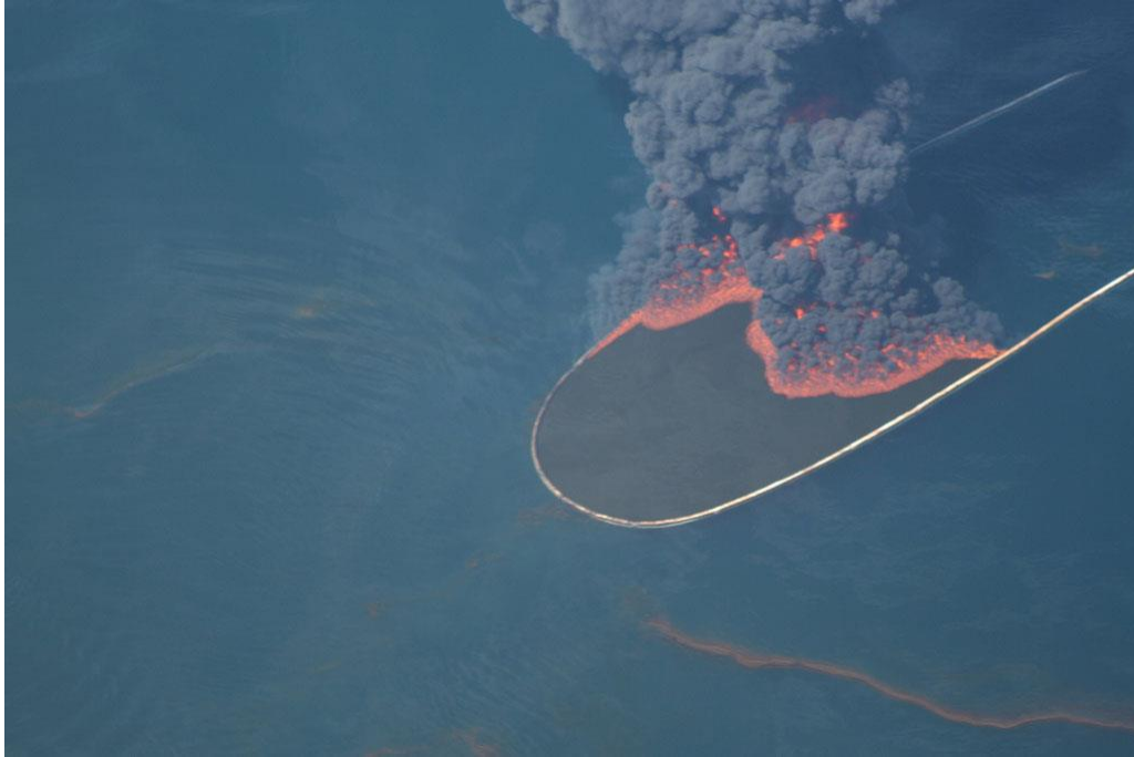
Slika 4-11: Kontrolirano spaljivanje nafte [32]
