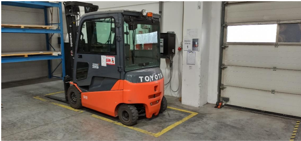
Slika 55 - Označena mjesta za elektromotorni viličar
