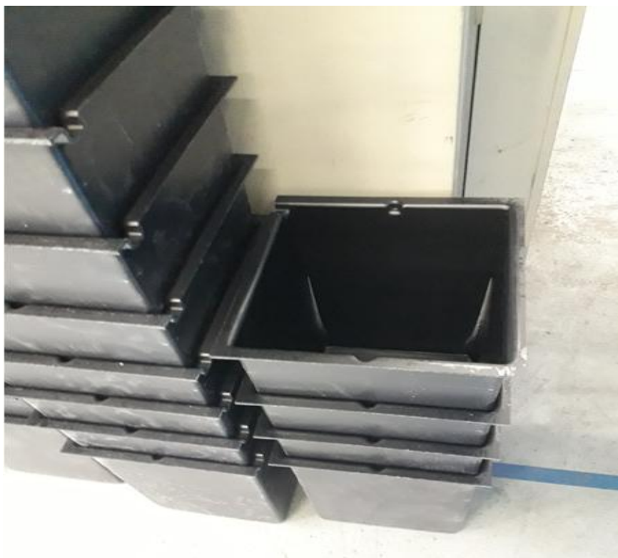
Slika 12. Posuda nakon otklanjanja viška materijala
