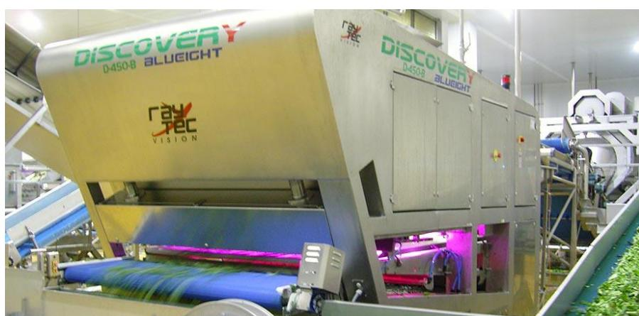
Slika 20: Oprema za sortiranje i inspekciju sirovine
