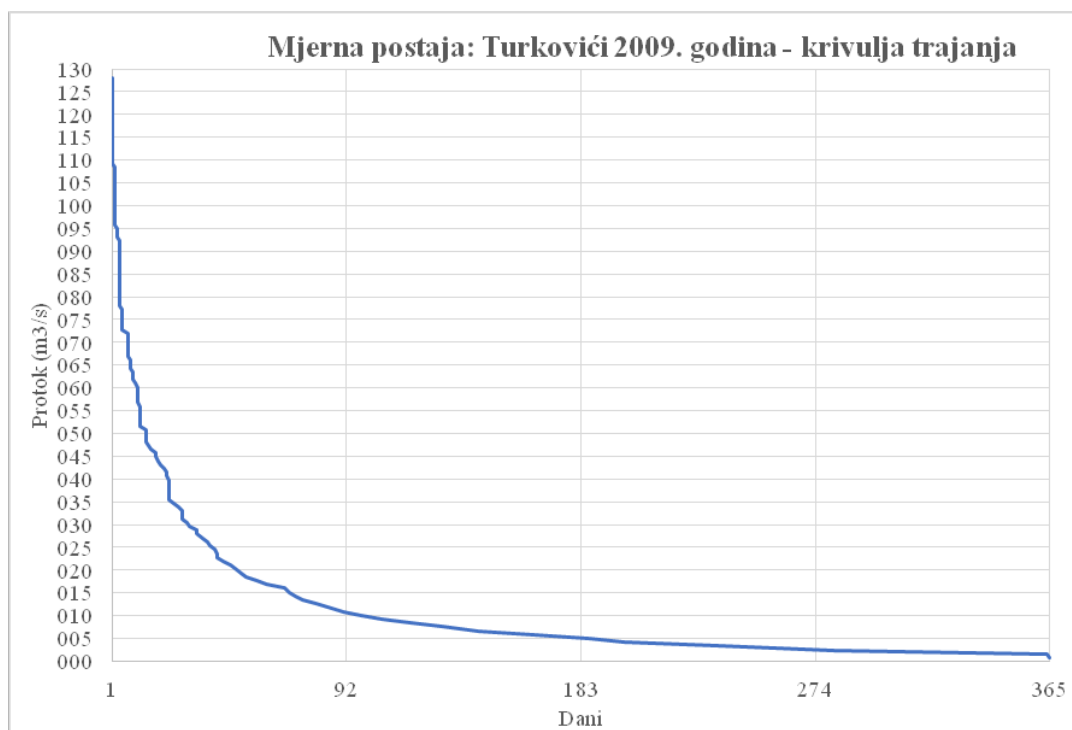
Prilog 11.4.1. Grafički prikaz krivulje trajanja protoka postaje Turkovići za 2009.god.
