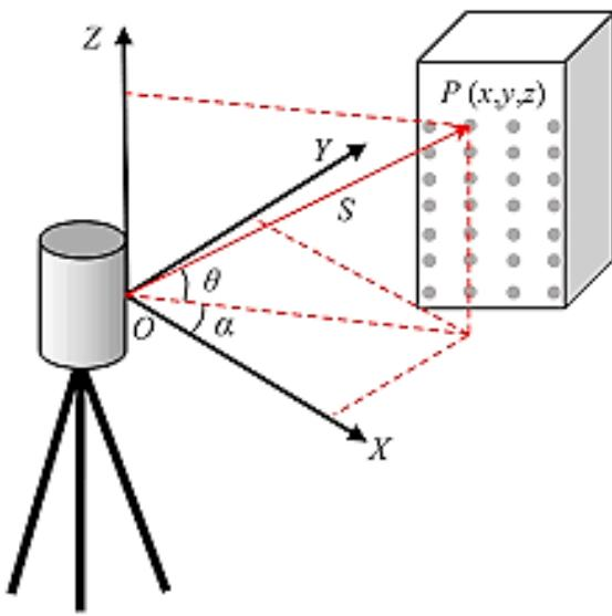
Slika 19. Princip rada laserskog skenera
