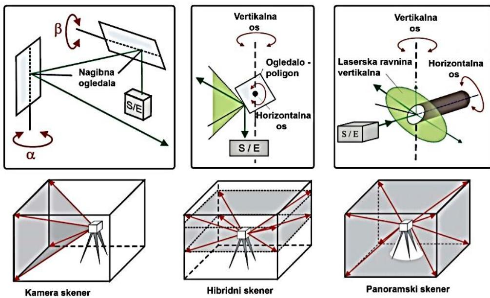
Slika 23. Prikaz tri vrste skenera prema načinu snimanja
