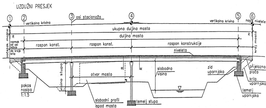
Slika 2. Primjer uzdužnog presjeka mosta
