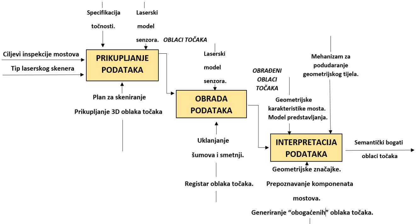
Slika 21. Predloženi postupak laserskog skeniranja na osnovi geometrijskog prikupljanja podataka za nadzor
