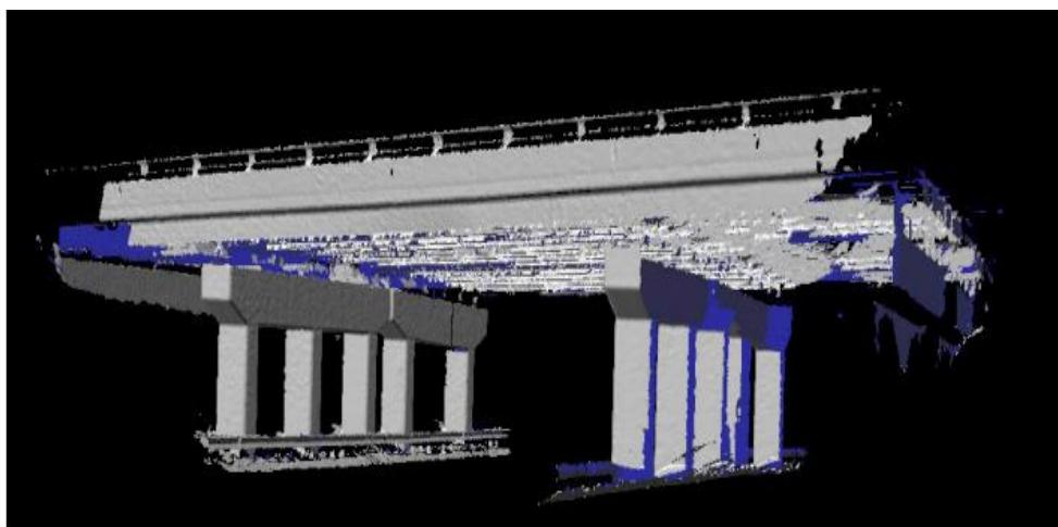
Slika 20. 3D model mosta iz laserski skeniranih podataka
