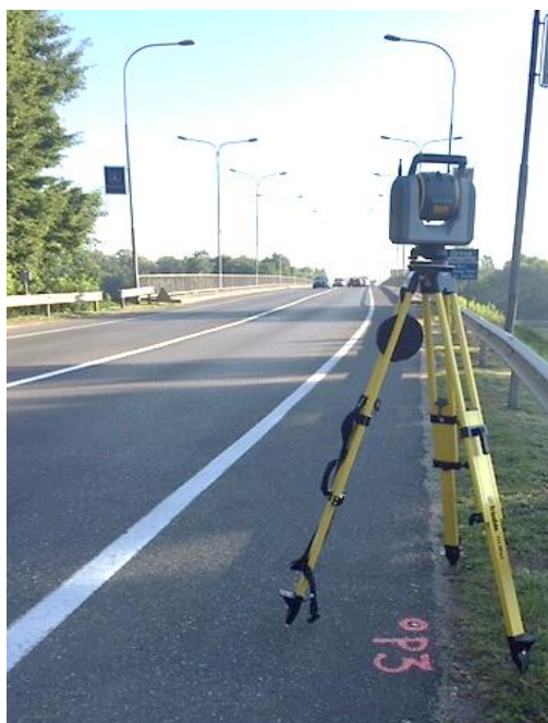
Slika 27. Trimble SX10 kod skeniranja mosta
