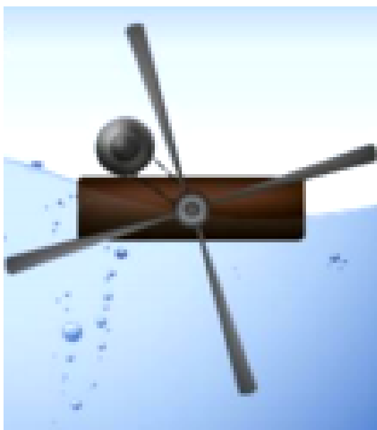
Slika 2.7. Turbina s osi paralelnom s ravninom vode [4]
