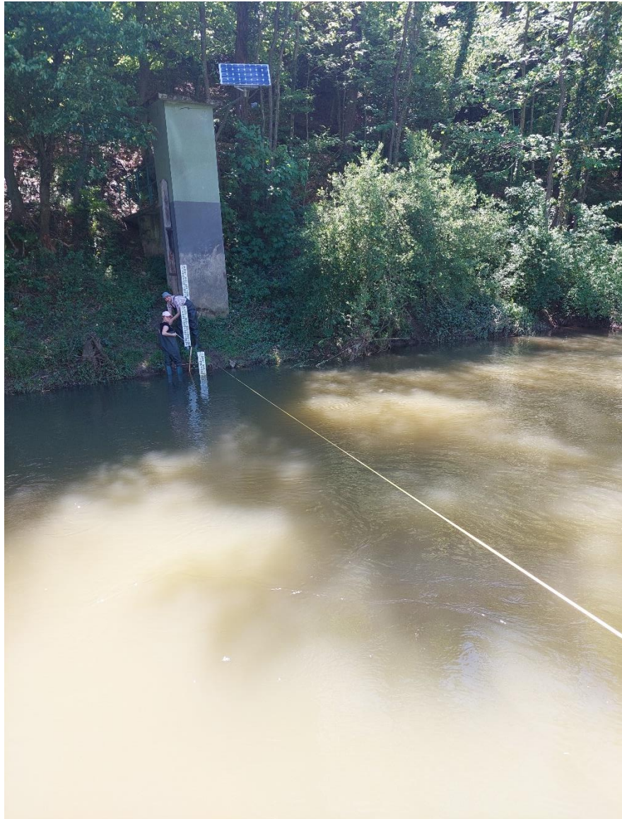
Slika 3.11. Lokacija mjerenja u Željeznici, uz prikaz mjerne letve
