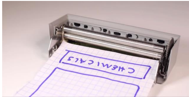
Slika 2.31: Prikaz mehanizma unutar polaroid kamere
