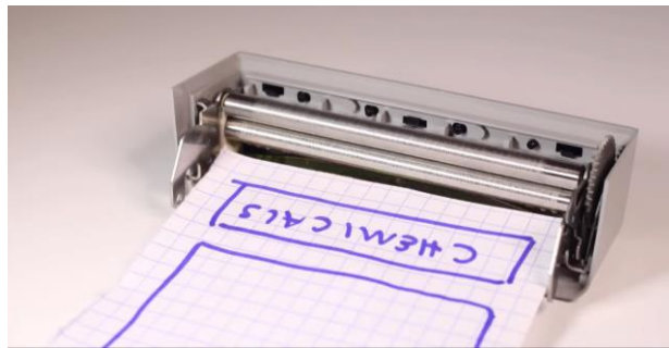
Slika 2.31: Prikaz mehanizma unutar polaroid kamere
