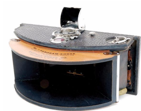
Slika 2.34: Verzija fotoaparata gdje se leća okreće kako bi se uslikala fotografija
