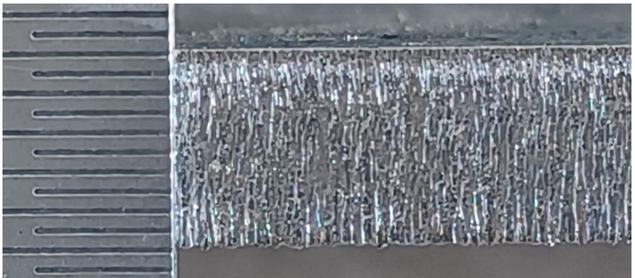
Slika 5.21 Rezna površina - konstrukcijski čelik - 90%
