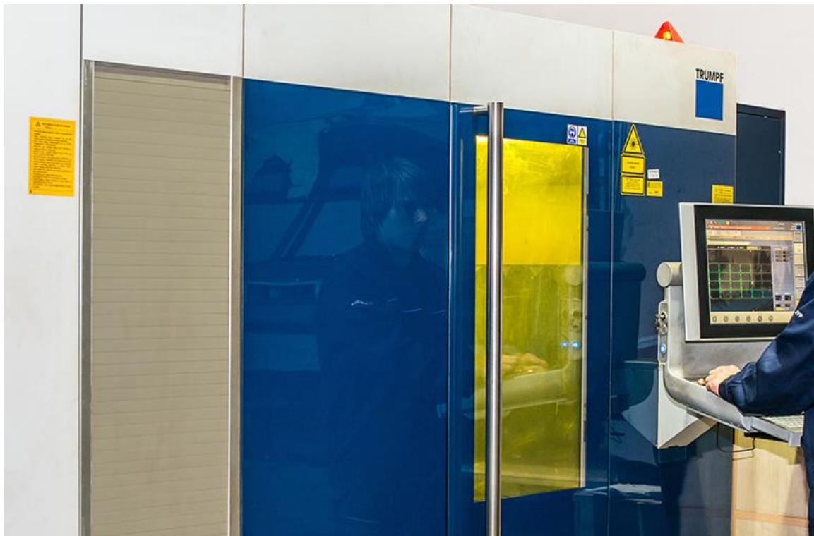
Slika 5.8 Trumpf fiber laser i upravljačka jedinica, [23]
