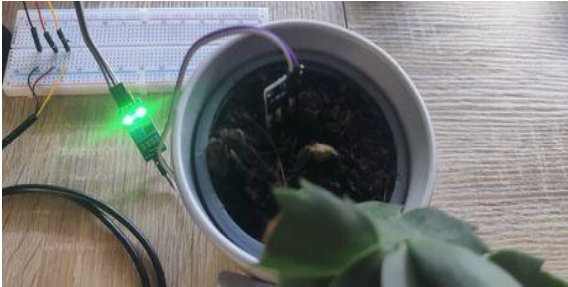
Slika 3.7 - Kalibriranje senzora vlage
