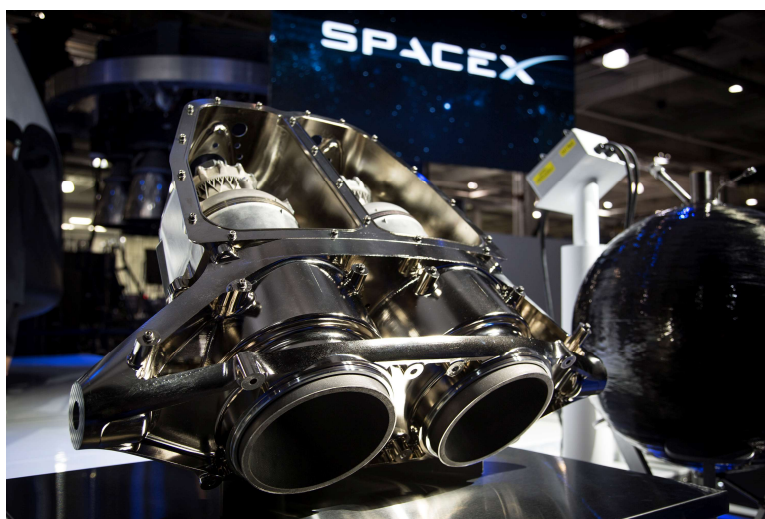
Slika 4.3 Raketni motor tvrtke SpaceX proizveden 3D ispisom [26]
