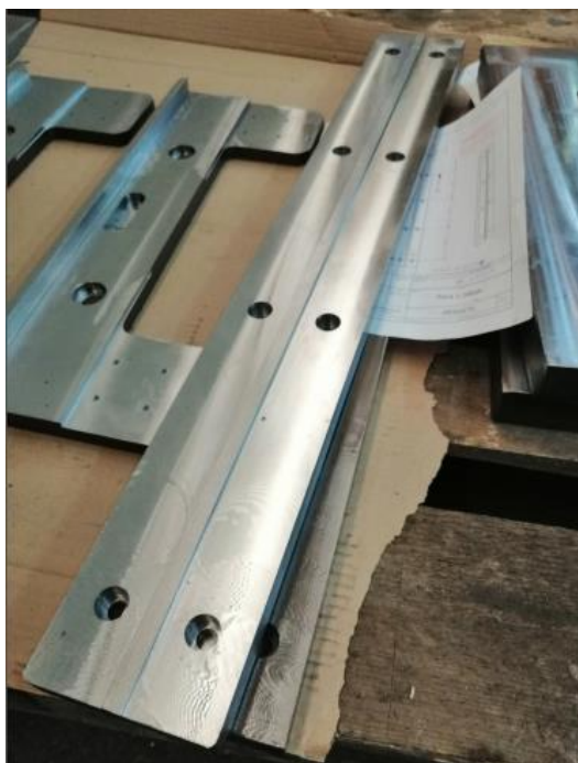
Slika 46. Ploča 1100 \times 150 \times 50 nakon obrade glodanjem
