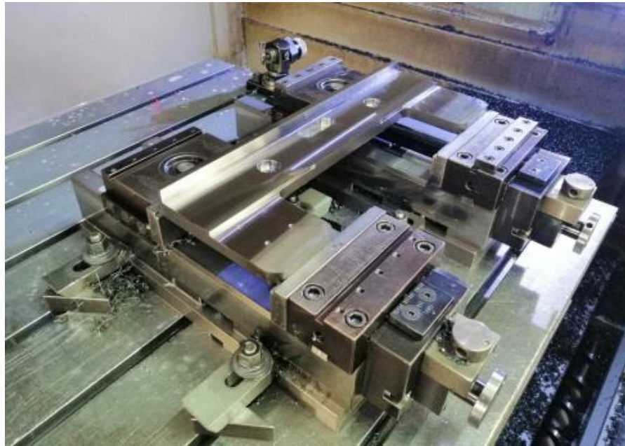
Slika 48. Ploča nosača stezaljki nakon obrade glodanjem
