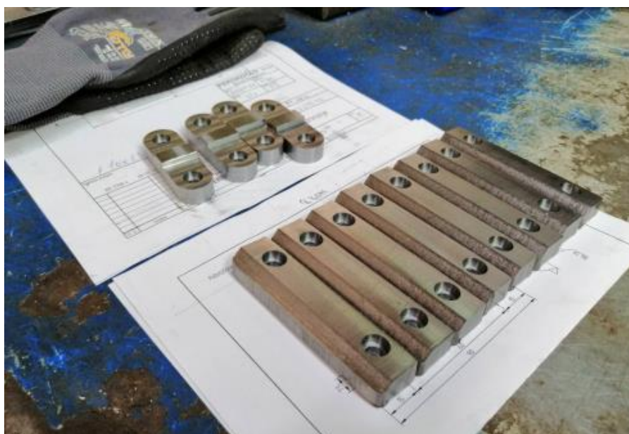
Slika 49. Alat za centriranje i graničnici nakon obrade glodanjem
