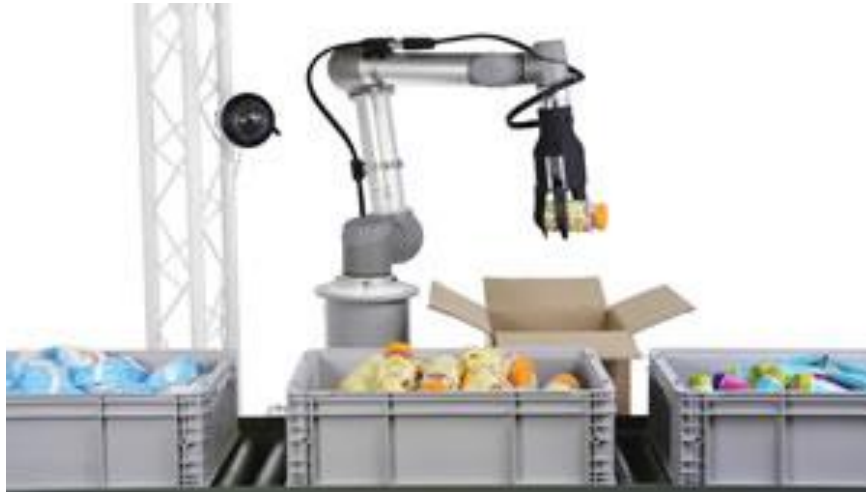
Slika 3. „Pick and place“ industrijski robot [11]
