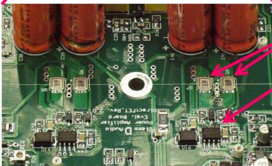
Slika 4.13 IRF6665 evaluacijska pločica,  $2 \times 150\text{W}$  izlazne snage uz iskoristivost oko 95% [14]
