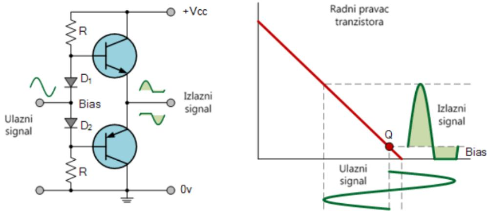
Slika 3.5 Shema i radni pravac tranzistora klase AB [18]
