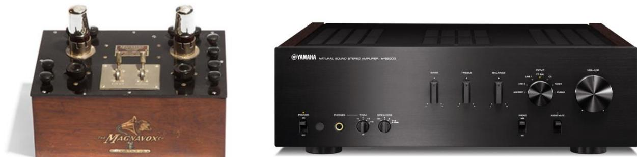
*Slika 2.1 Lijevo je Magnavox (cijevno) pojačalo iz 1921. godine, desno moderno Yamaha (tranzistorsko) pojačalo [14]*
