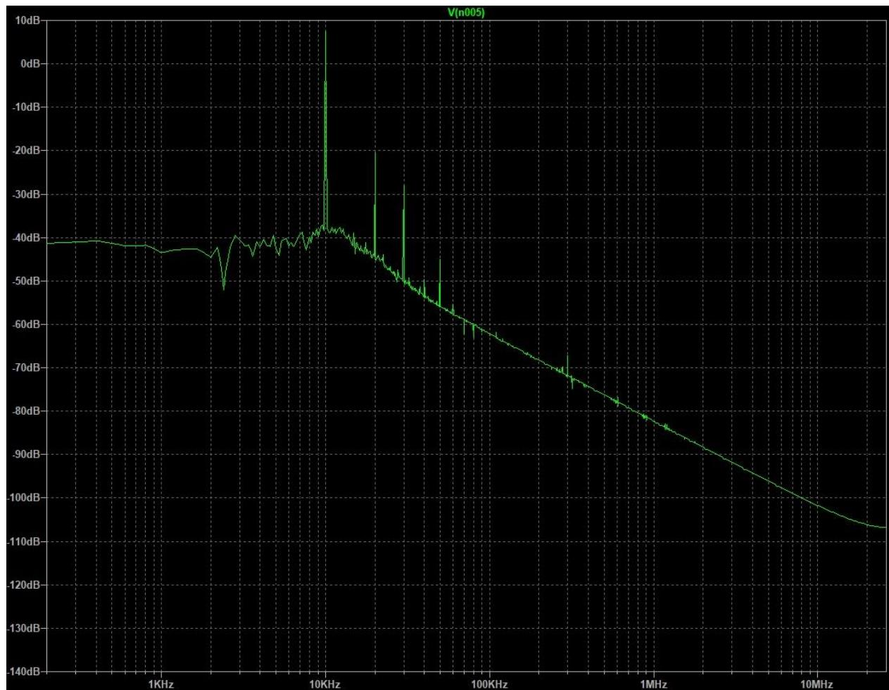
Slika 5.8 FFT analiza filtriranog signala
