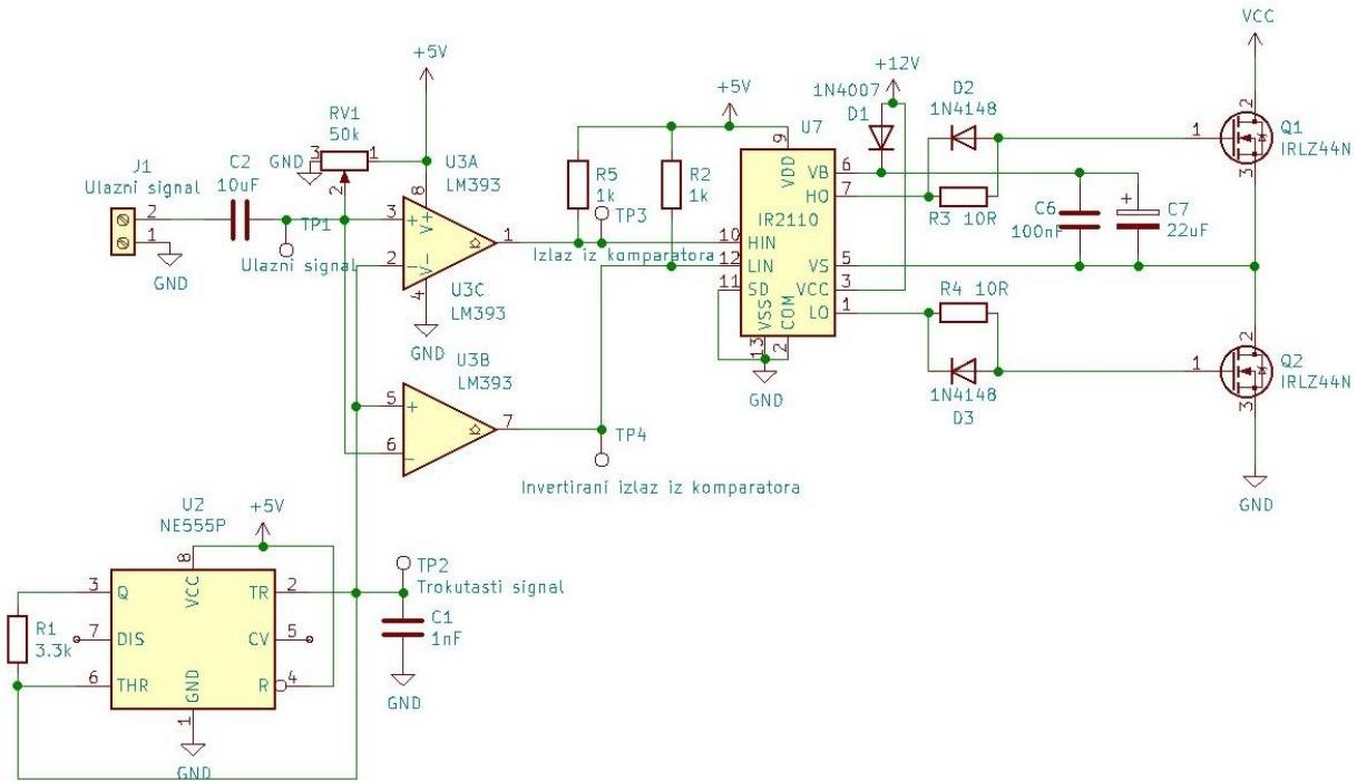
Slika 5.6 Shema za moduliranje i pojačavanje signala
