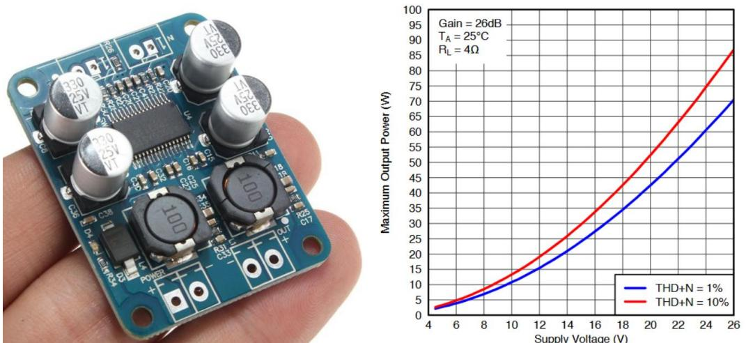
Slika 4.10 Primjer pojačala sa TPA3118 i ovisnost izlazne snage od naponu napajanja [24]
