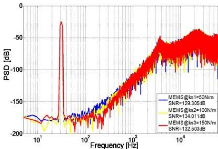
Slika 4.8 Primjer amplitudno frekvencijske karakteristike delta-sigma modulatora [22]
