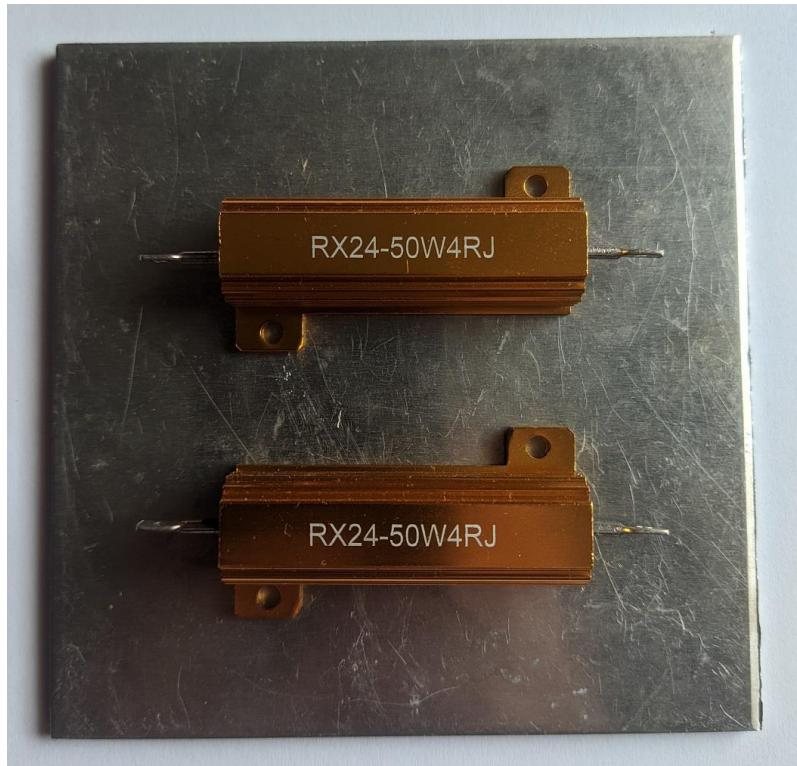
Slika 6.5 Otpornici korišteni za testiranje
