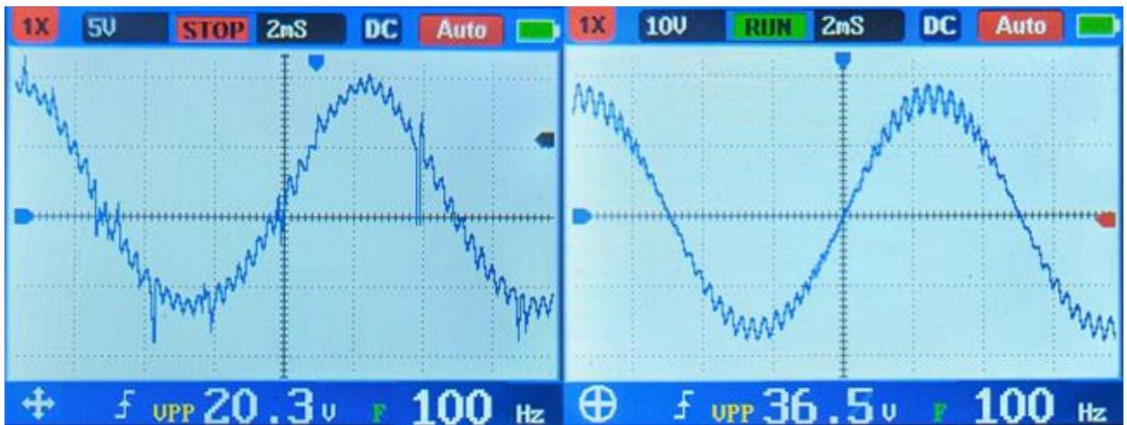
Slika 6.4 Izlaz pojačala iz ovog rada (lijevo) i komercijalnog rješenja (TPA3118),  $f=100\text{Hz}$
