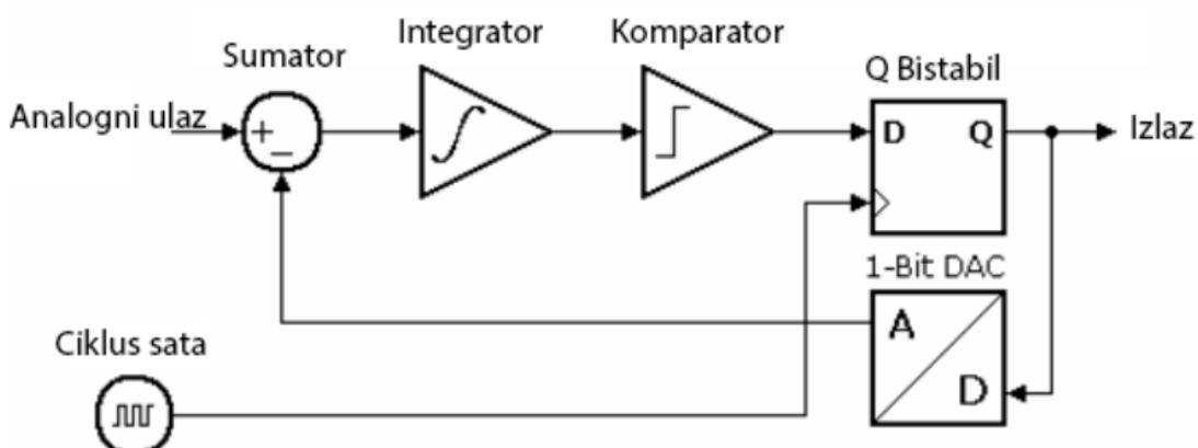
Slika 4.3 Blokovski prikaz Delta-Sigma modulatora prvog reda [7]
