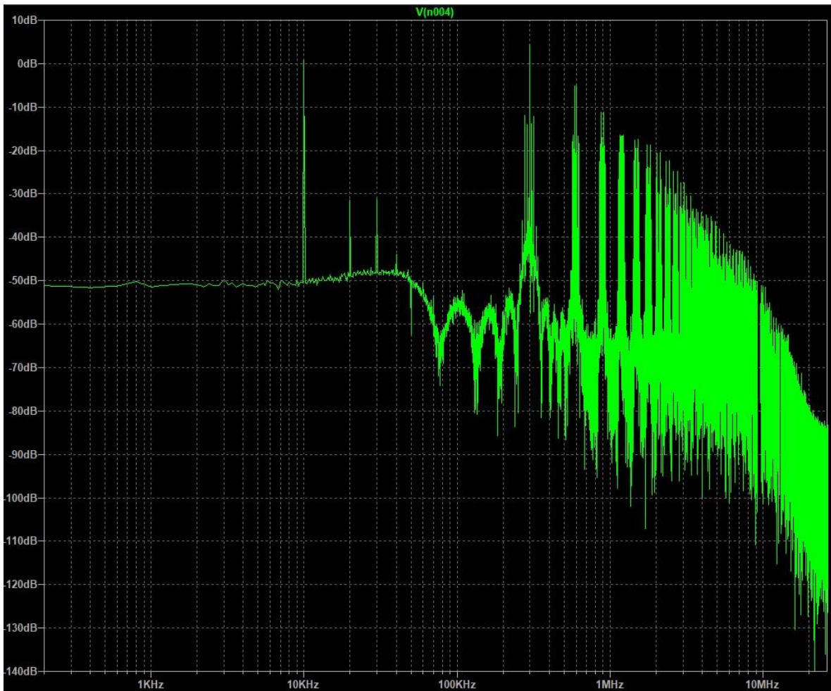
Slika 5.7 FFT analiza modulatora
