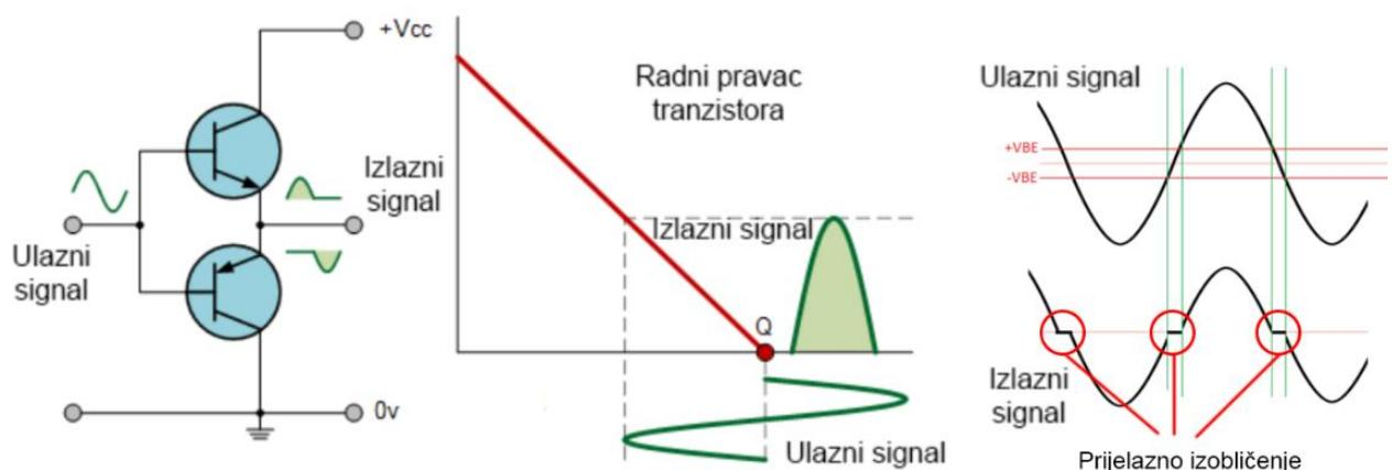
Slika 3.4 Shema i radni pravac tranzistora klase B [9]
