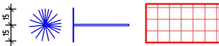
Slika 54. Lijevo je prikazano karbonsko užje, desno staklena mreža
