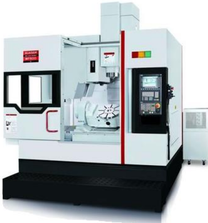
Slika 3.12 Glodaći obradni centar s pet upravljanih osi [23]
