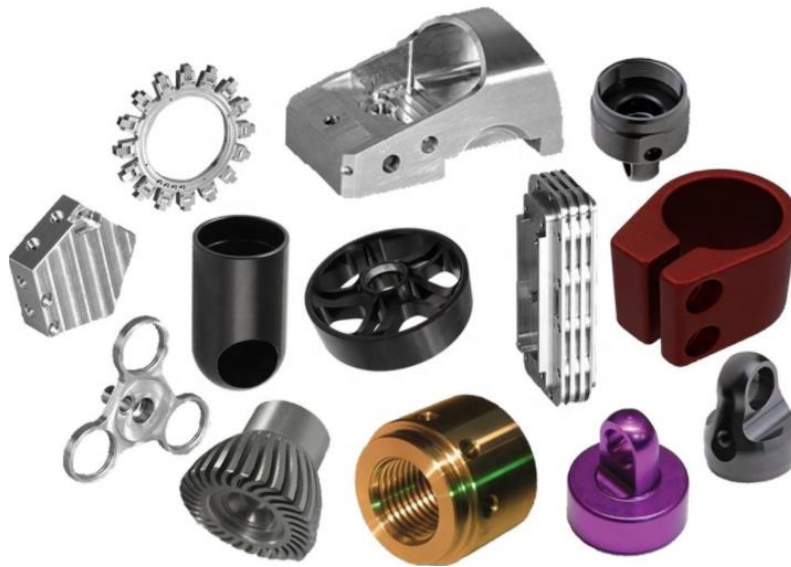
Slika 3.13 Gotovi izratci obrade glodanjem [24]
