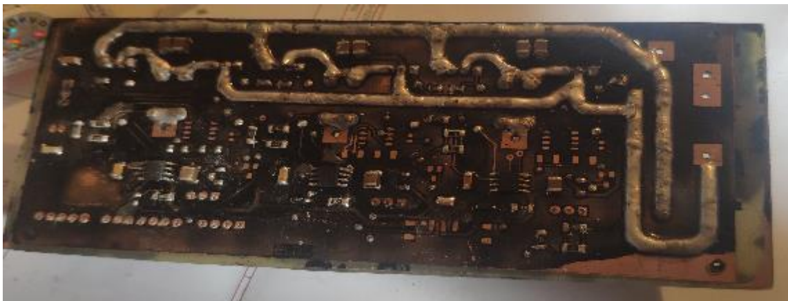
Slika 5.7-zalemljene komponente na donju stranu pločice
