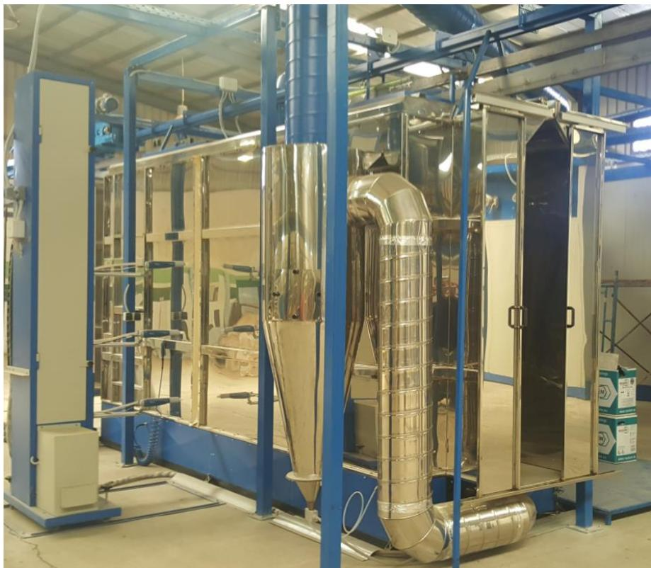
Slika 5.7. Komora za elektrostatski nanos bojila u prahu [24]
