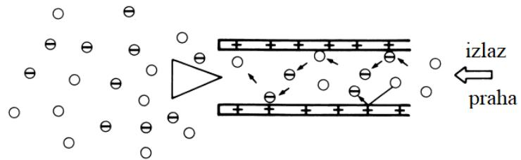
Slika 5.10. Shematski prikaz mehanizma elektrostatskog nanošenja praha (tribo-pištanj);
