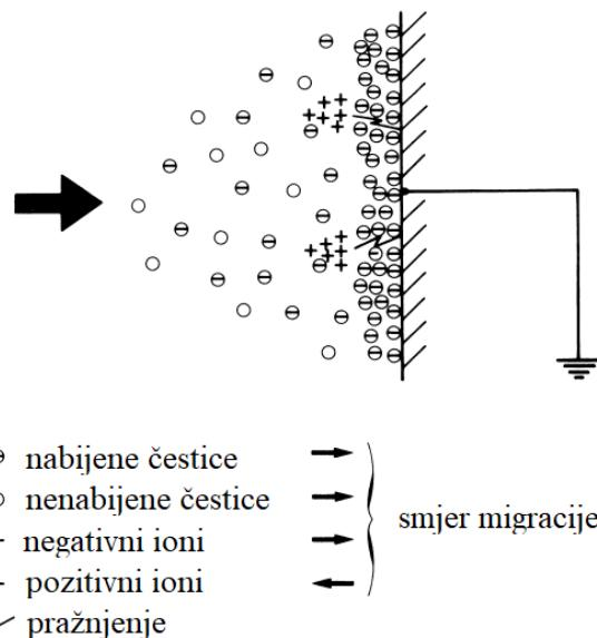
Slika 5.11. Shematski prikaz procesa povratne ionizacije u nanešenom sloju čestica praha
