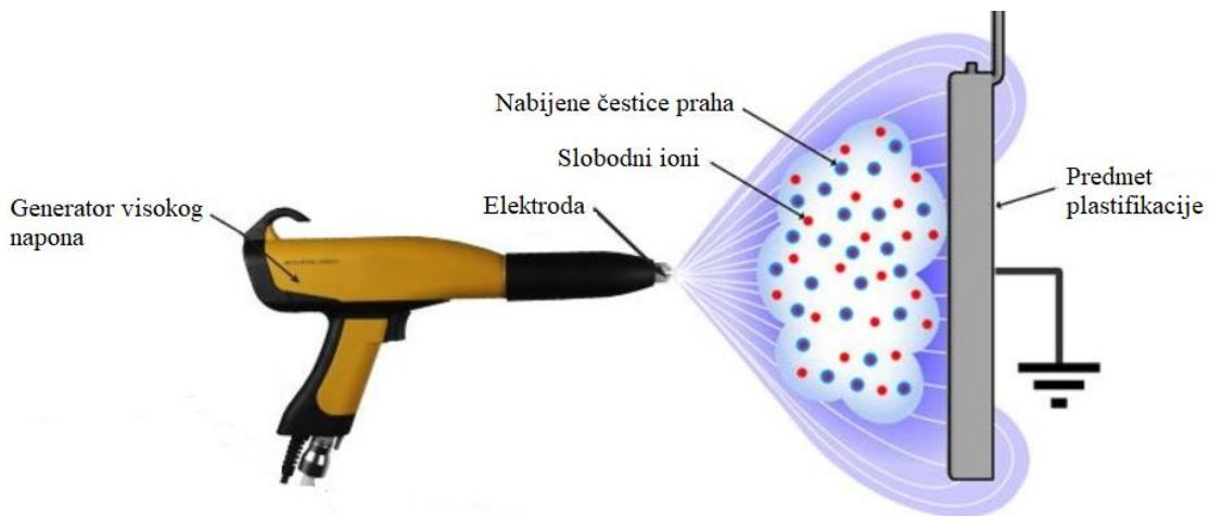
Slika 5.8. Pištolj za elektrostatski nanos bojila u prahu [25]
