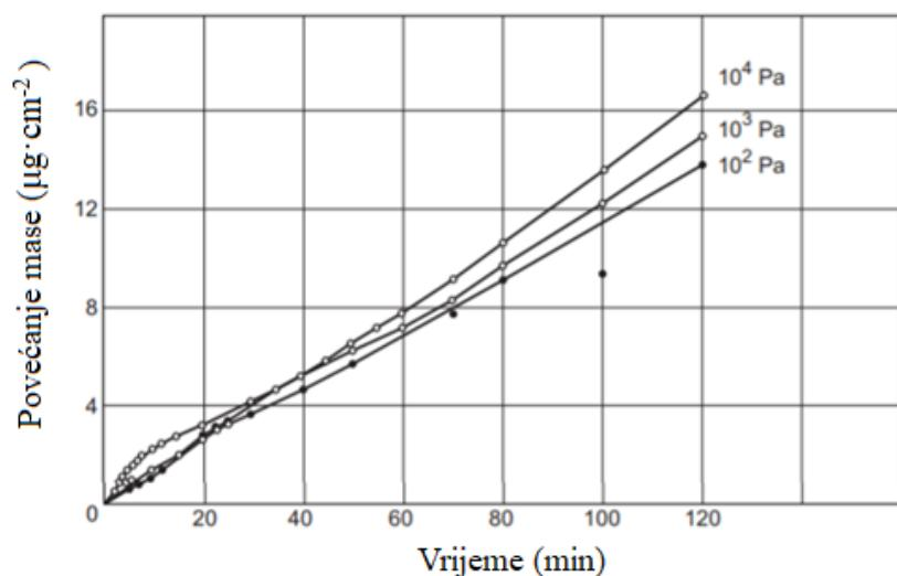
Slika 5.2. Utjecaj tlaka kisika na nastajanje oksidnog sloja pri temperaturi od  $500^\circ\text{C}$  [14]
