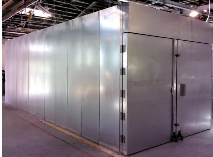
Slika 5.15. Peć za polimerizaciju bojila u prahu u industriji plastifikacije metala [29]
