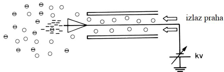
Slika 5.9. Shematski prikaz mehanizma elektrostatskog nanošenja praha (*corona charging*);
