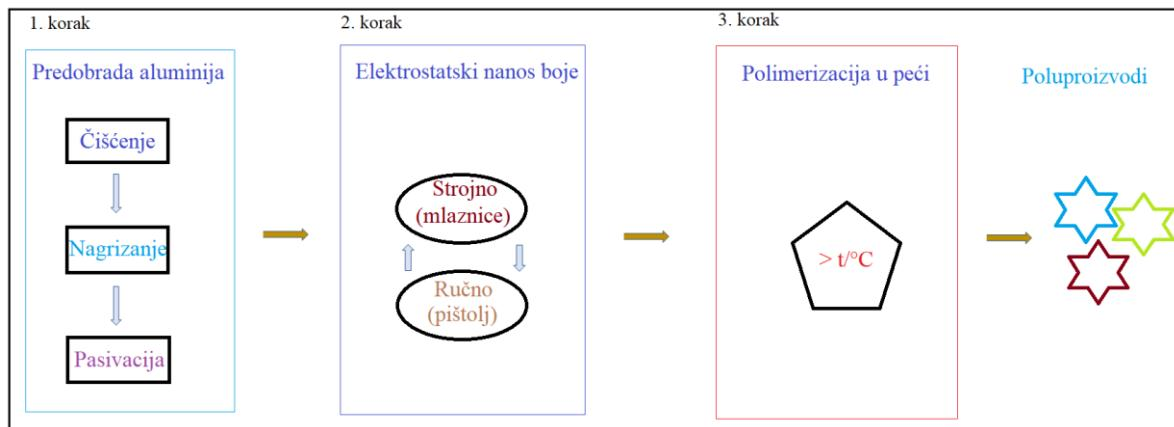
Slika 5.16. Shematski prikaz tehnološkog procesa plastifikacije metala
