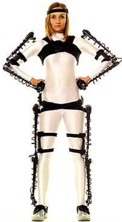
Slika 25 Oprema mehaničkog sustava za snimanje pokreta, izvor: https://metamotion.com/gypsy/gypsy-motion-capture-system-workflow.htm
