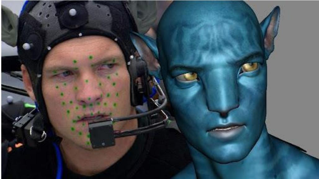
Slika 22 Prikaz markera za snimanje pokreta lica, izvor: <http://kinectic.net/motion-capture-face/>
