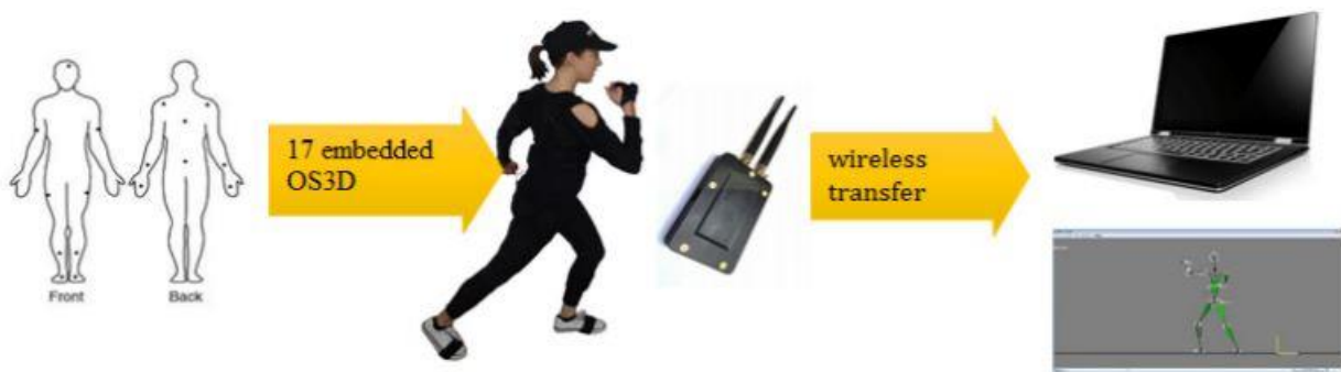
Slika 29 Struktura i sučelje sustava za snimanje pokreta [5]
