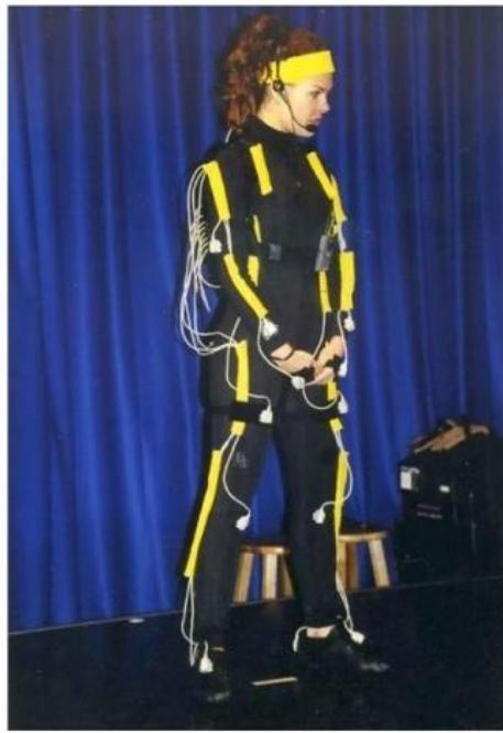
Slika 23 Oprema magnetskog sustava za hvatanje pokreta, izvor:
