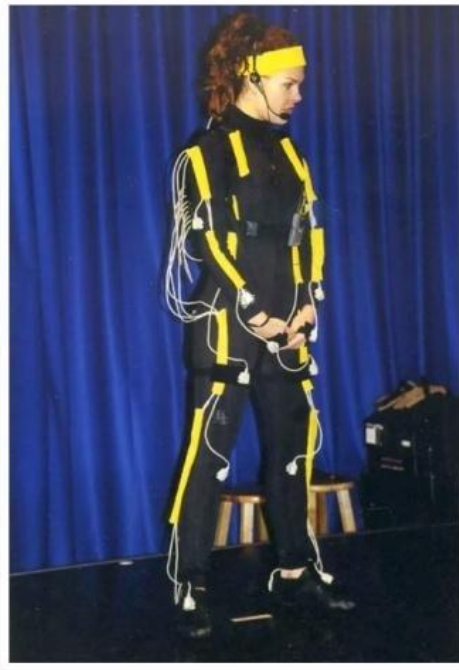
Slika 23 Oprema magnetskog sustava za hvatanje pokreta, izvor:
