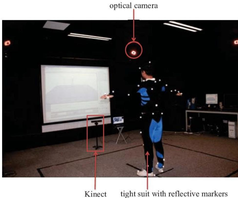
Slika 24 Oprema optičkog sustava za snimanje pokreta, izvor:
