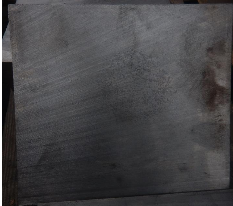
Slika 2.20 Područje chunky grafita nakon rezanja odljevka [7]
