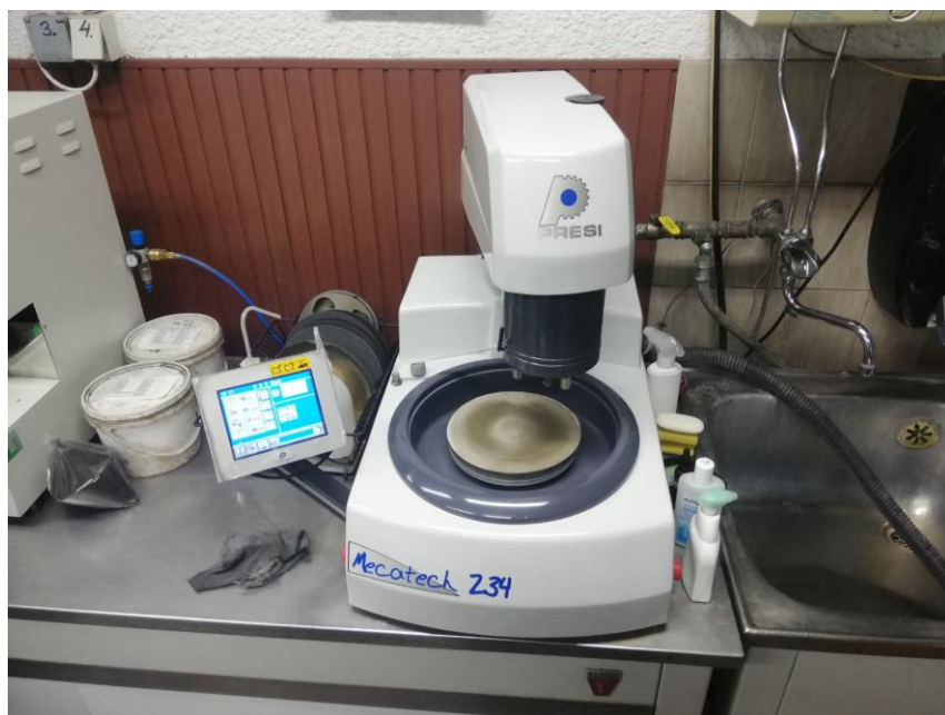
Slika 3.13 Uređaj za brušenje i poliranje metalografskih uzoraka [7]
