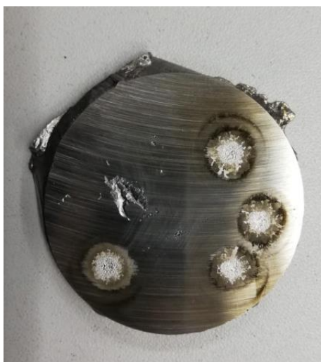
Slika 3.9 Ispitni uzorak za kemijsku analizu [7]
