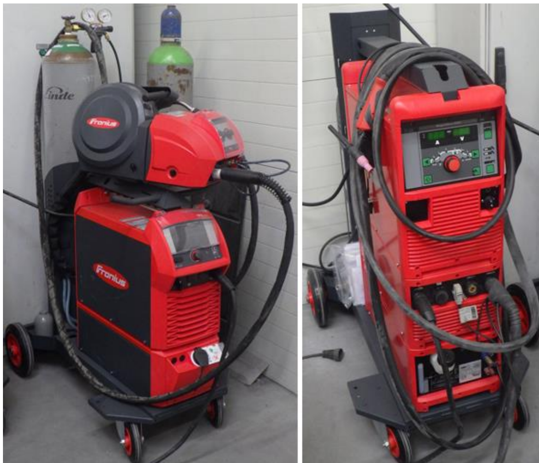
Slika 7.3 Uredaji za MIG i TIG postupke zavarivanja
