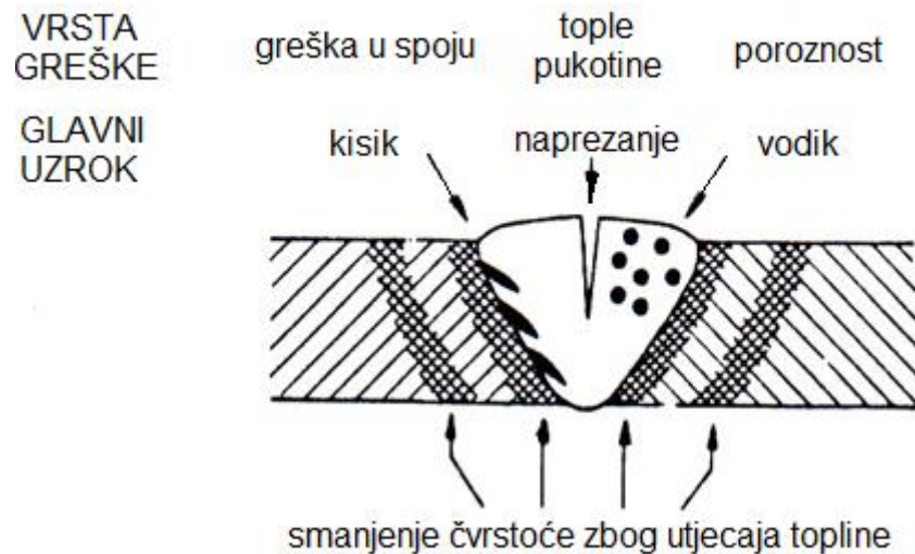
Slika 4.1 Pogreške i uzroci na poprečnom presjeku zavra [7]
