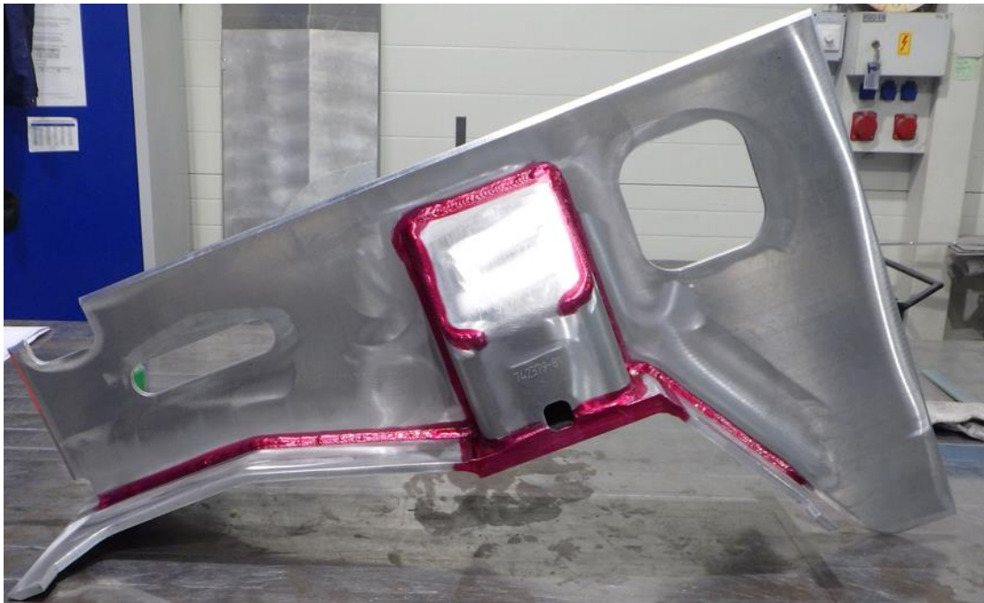
Slika 8.3 Nanesen penetrant na ispitnu površinu konzole
