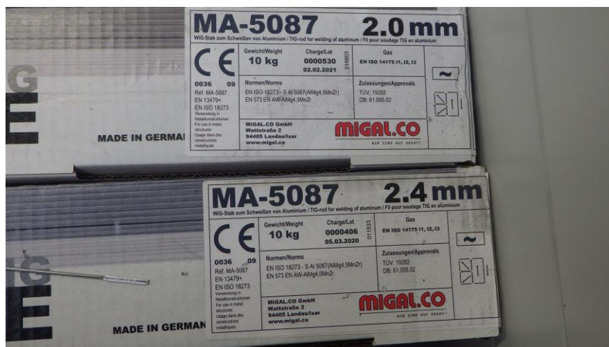
Slika 7.2 Dodatni materijal u obliku šipke za TIG zavarivanje
