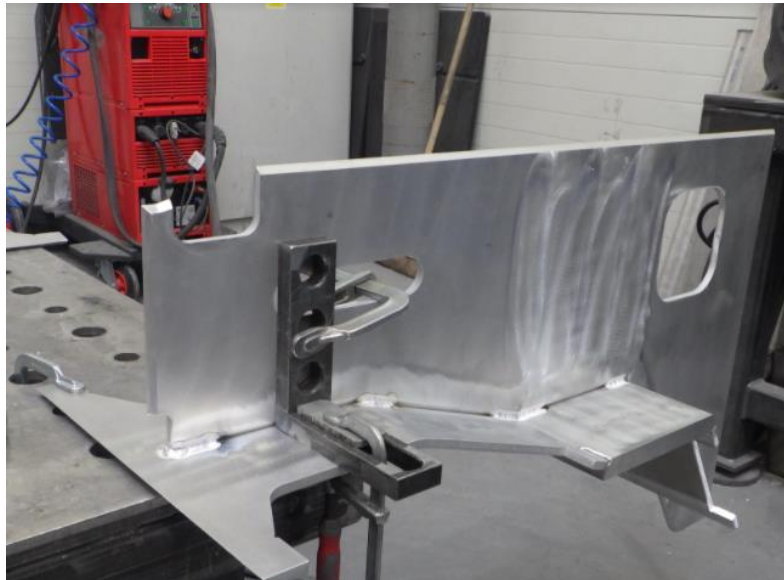
Slika 7.7 Spajanje donjeg segmenta i stražnje ploče
