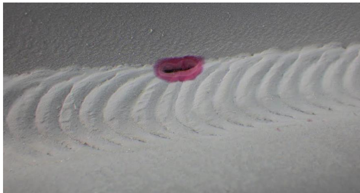
Slika 8.10 Neprotaljen rub faze zavara BW 4HY/4HY
