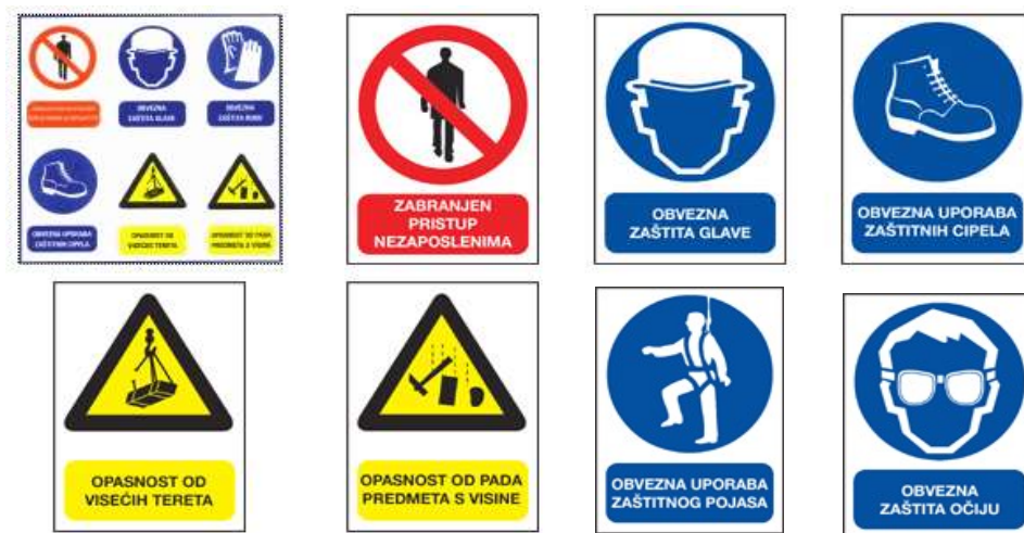
Slika 3.2 Ploče oznaka Zaštite na radu na gradilištu [1]
