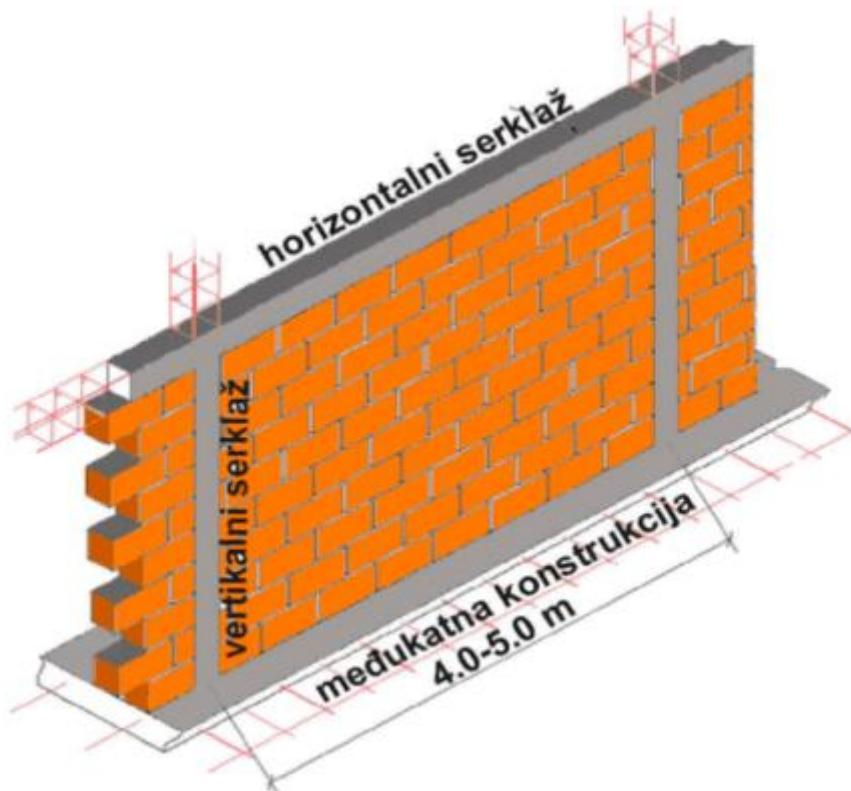
*Slika 3: Omeđeno zidje vertikalnim i horizontalnim serklažima*
