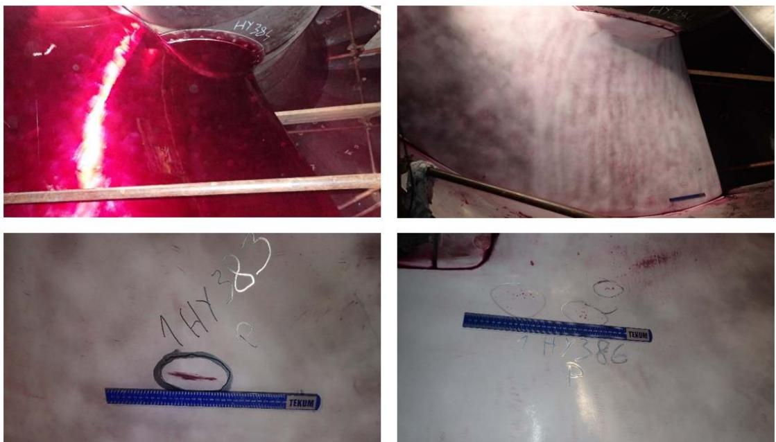
*Slika 26. Oštećenja utvrđena penetrantskom metodom*
