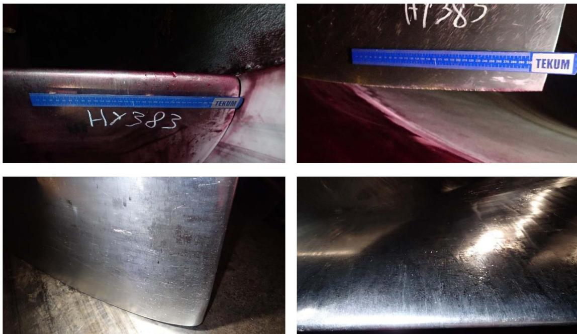
Slika 25. Površinske greške utvrđene vizualnom metodom ispitivanja
