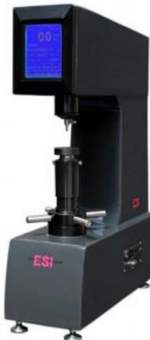
*Slika 9. Uređaj za ispitivanje tvrdoće po Vickersu*
