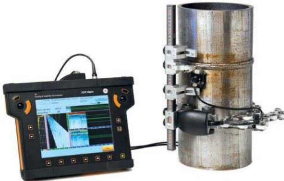
Slika 18. Uređaj za ultrazvučno ispitivanje
