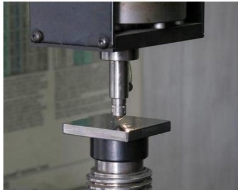
Slika 7. Uredaj za ispitivanje tvrdoće po Vickersu
