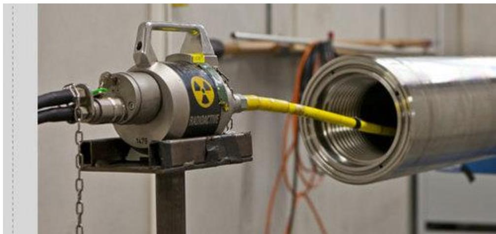
Slika 23. Primjena radiografskog ispitivanja
