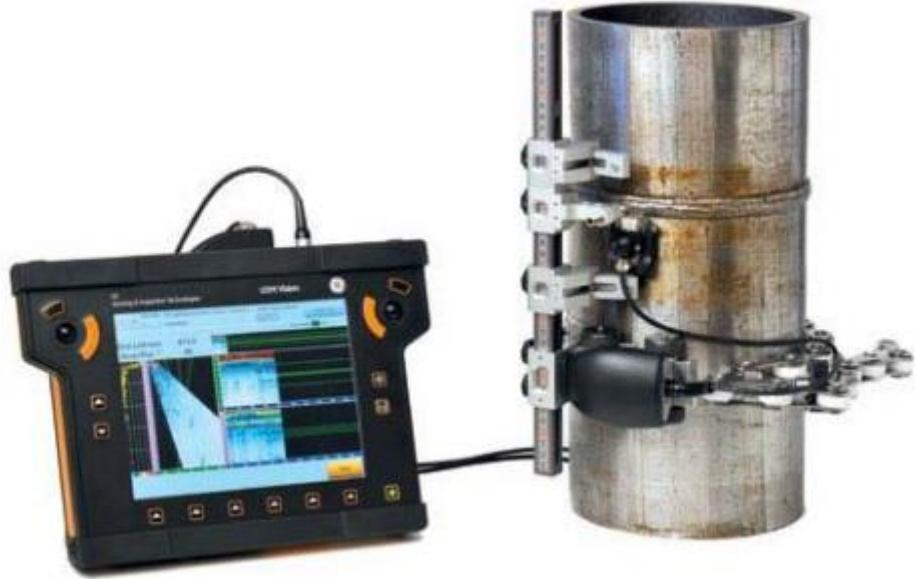
Slika 18. Uredaj za ultrazvučno ispitivanje
