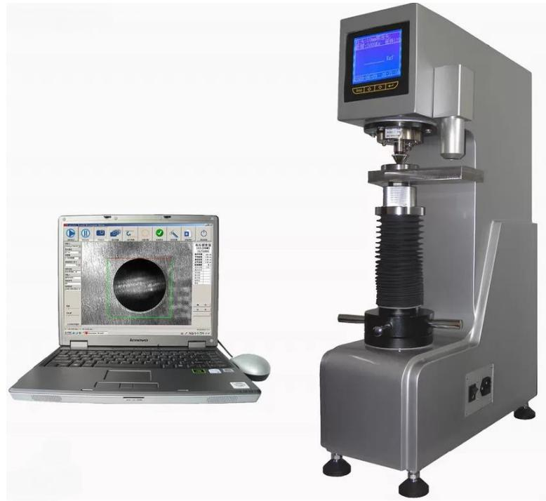
*Slika 5. Uređaj za ispitivanje tvrdoće po Brinellu*
