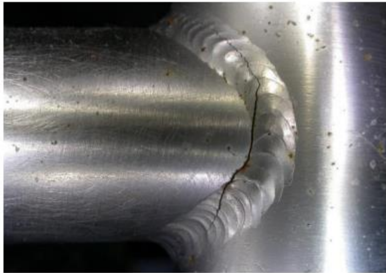
Slika 14. Pukotina otkrivena pomoću VT
