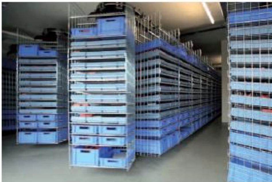
Slika 4.13 Izgled Kardex Remstar horizontalnog karusela. [10]
