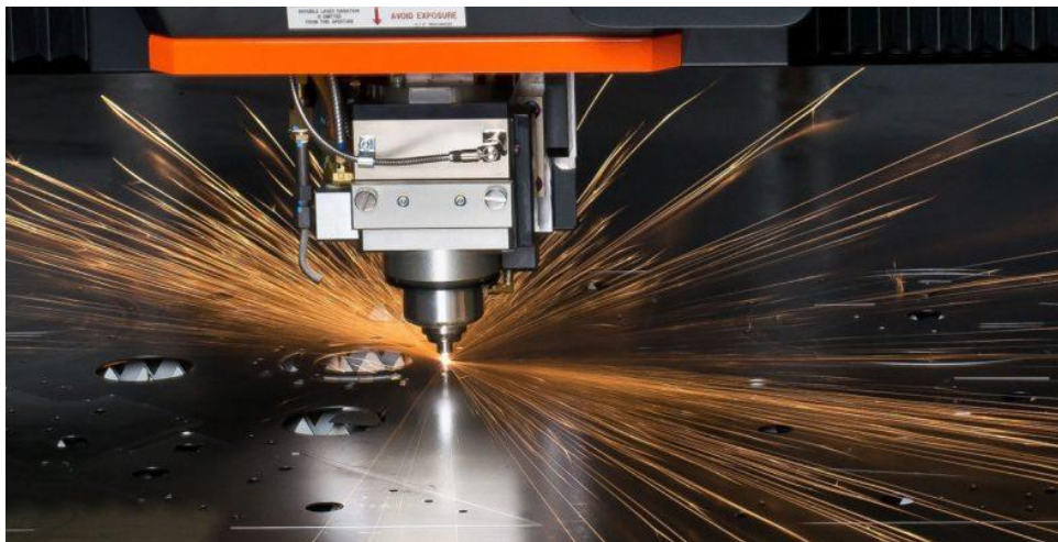
Slika 20. Lasersko rezanje lima [37]
