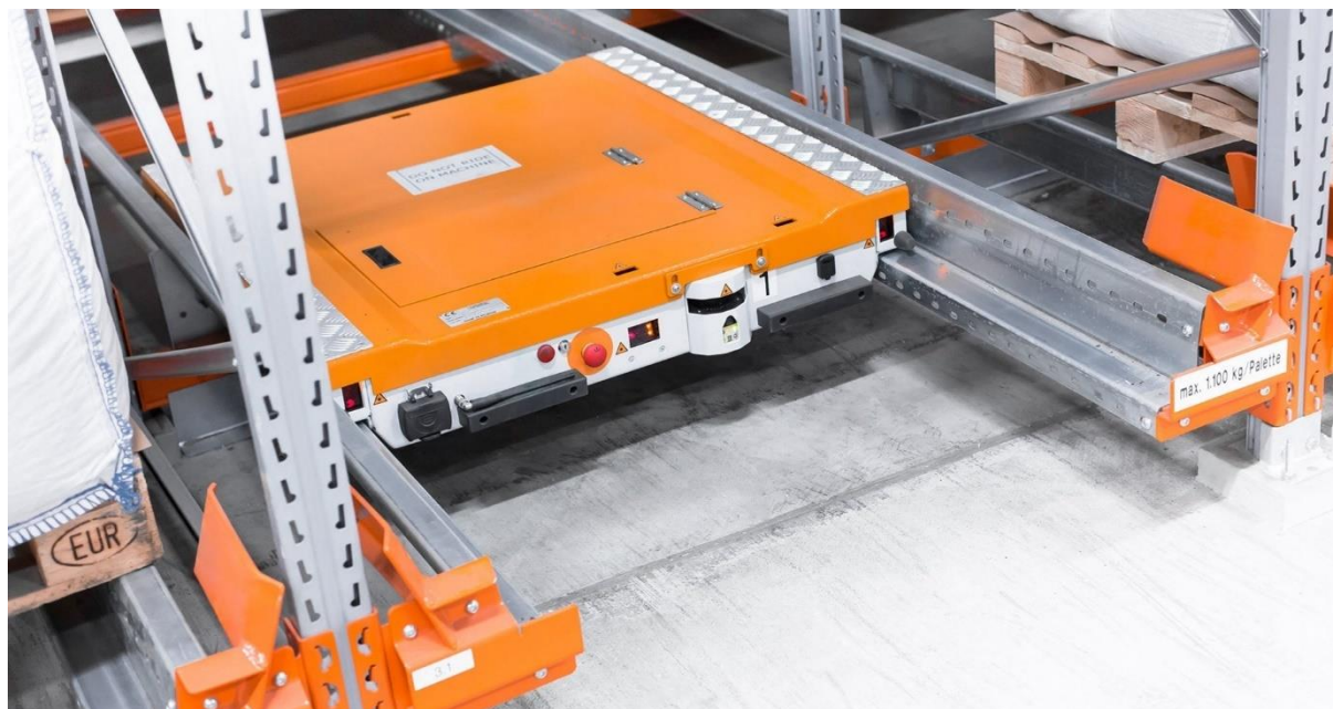
Slika 3.3.1. – STILL paletni shuttle regalni sustav [8]
