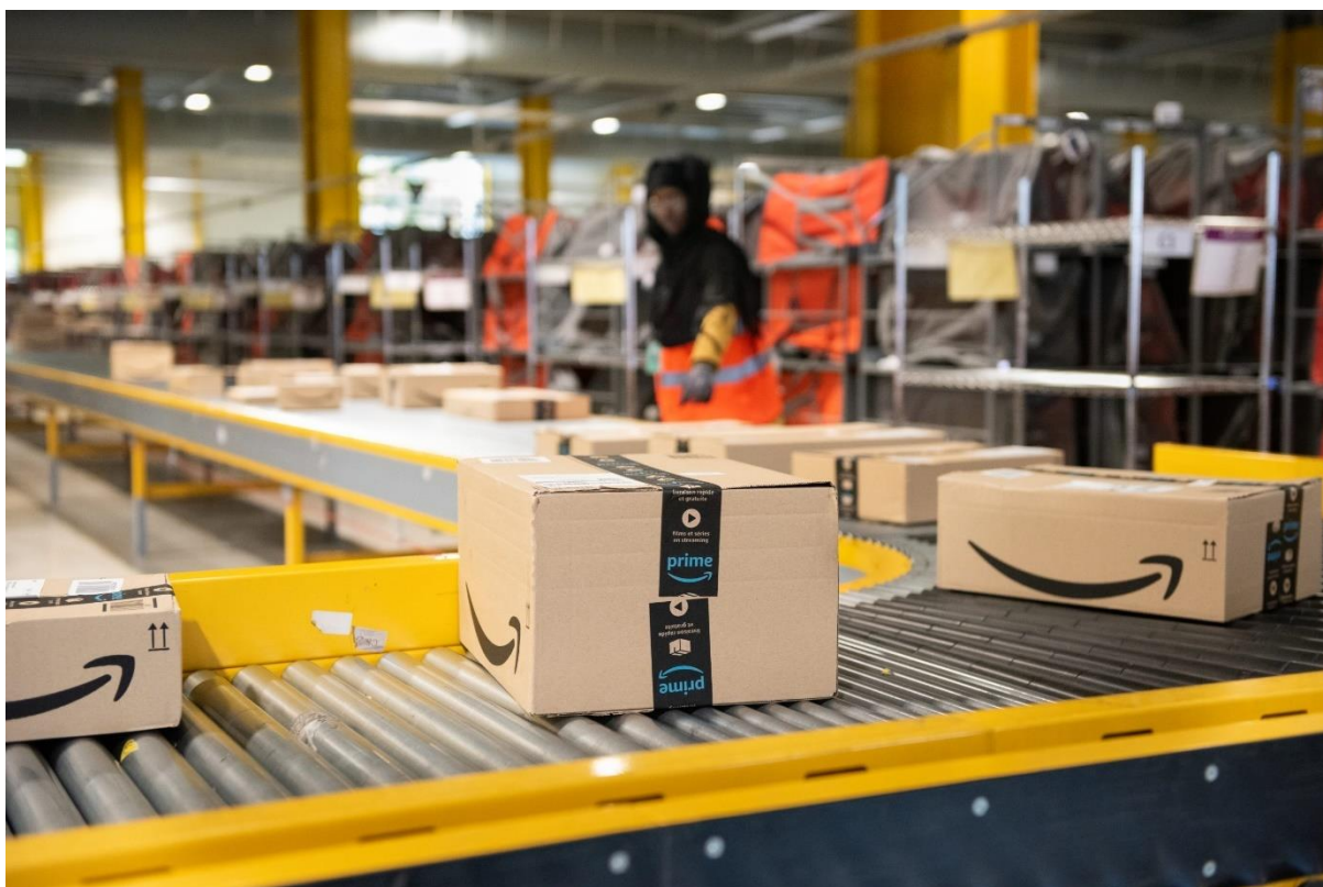
Slika 2.5.4. Valjčani konvejer u sklađištu Amazona [17]
