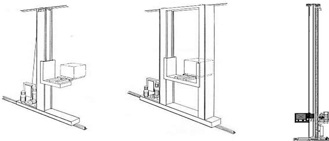
Slika 2. Prikaz automatizirane visokoregalne (unit load )S/R dizalice [16]
