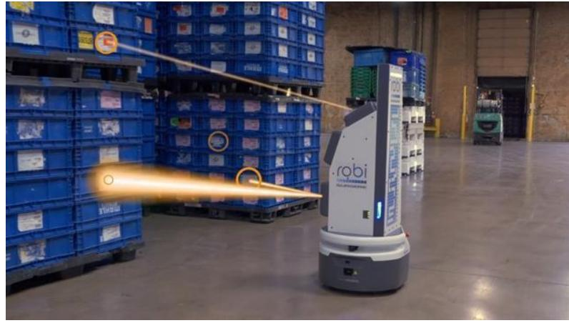
Slika 15: Prikaz autonomnog robota za inventuru [34]
