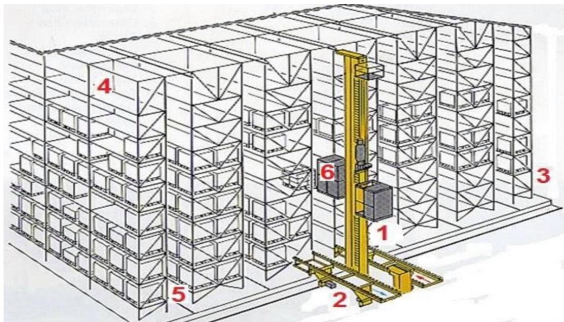
Slika 1. Prikaz visokoregalnog automatiziranog sustava sa pripadajućim komponentama [12]
