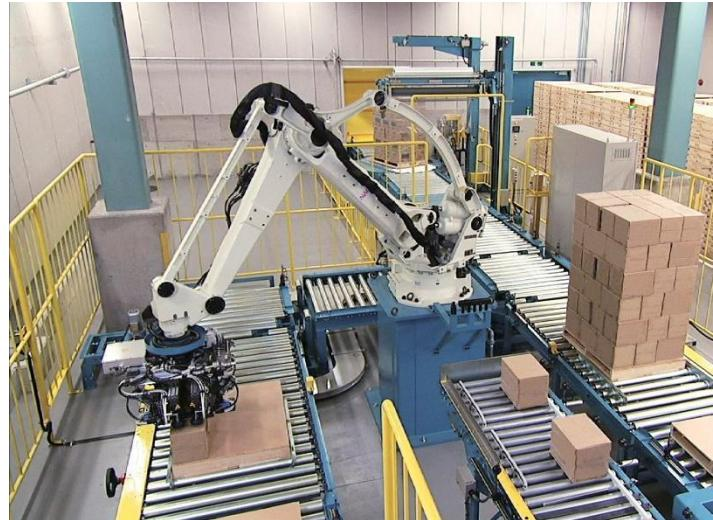
Slika 17: Robotski sistem paletizacije [36]
