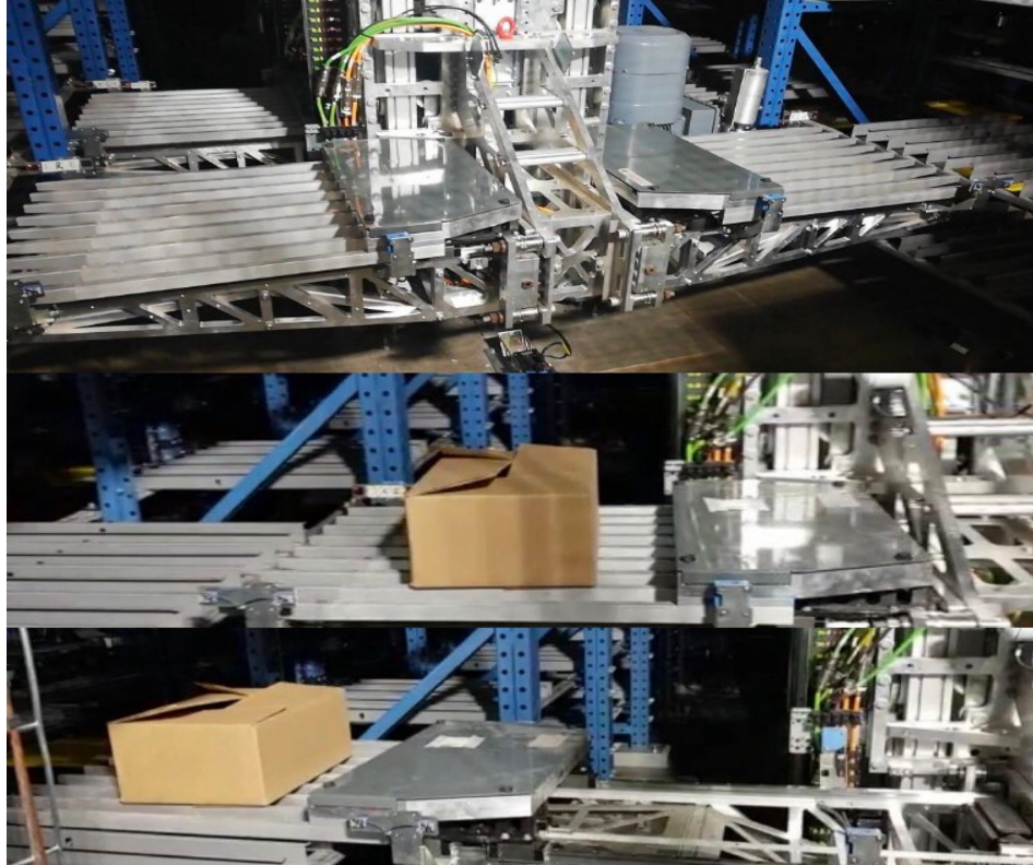
Slika 23: Prikaz dizalice i specifične ruke (tzv. LDH) sa lijeve i desne strane
