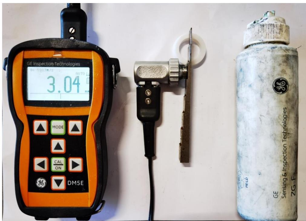
Slika 12. Instrument i oprema za ultrazvučno mjerjenje debljine stjenke
