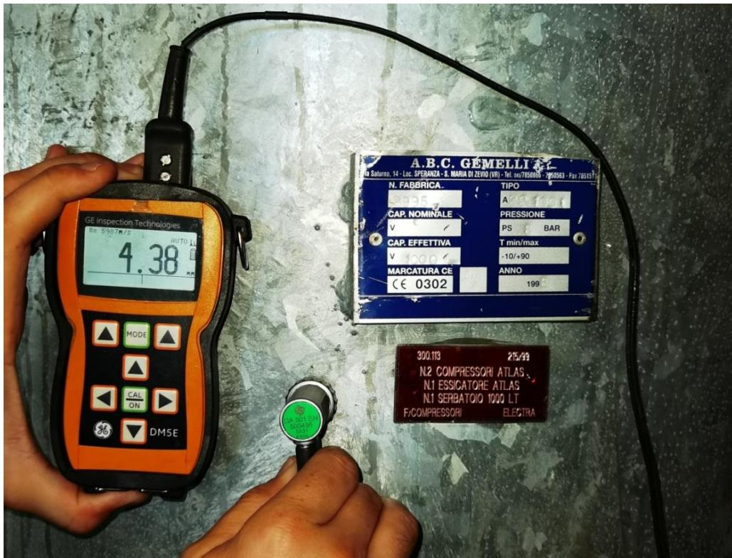
Slika 11. Ultrazvučno mjerjenje debljine stjenke
