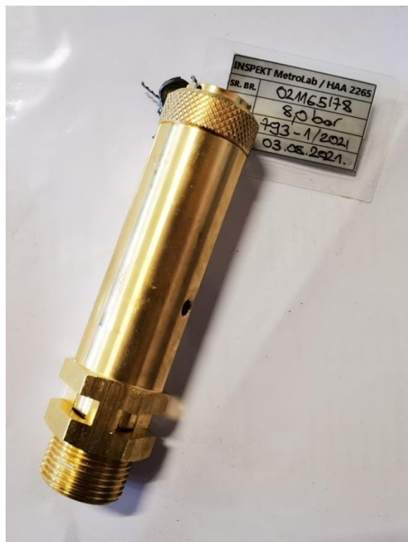
Slika 8. Sigurnosna oprema – sigurnosni ventil
