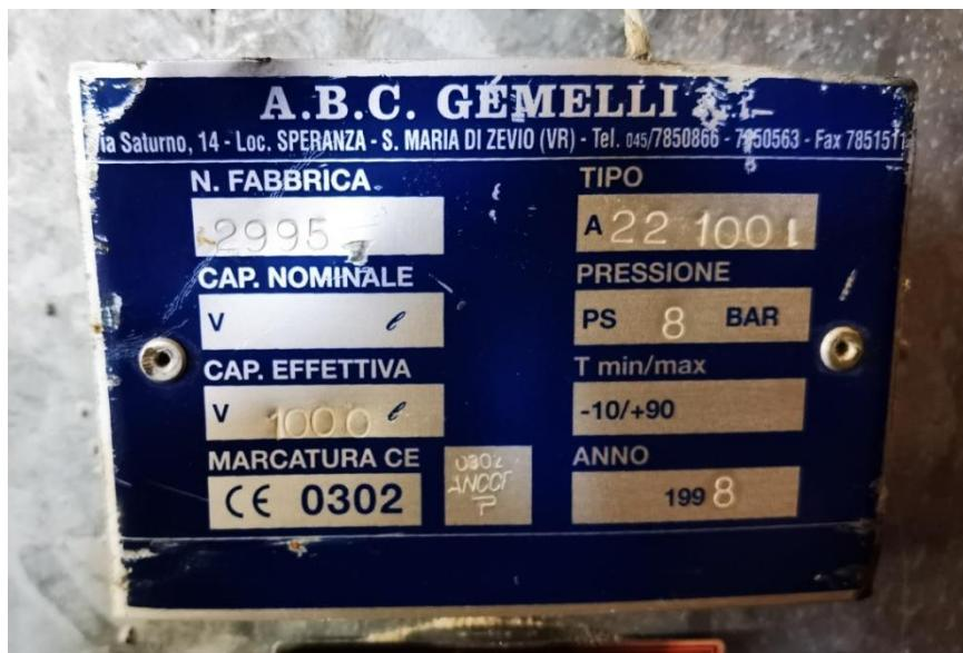
Slika 7. Natpisan pločica spremnika zraka
