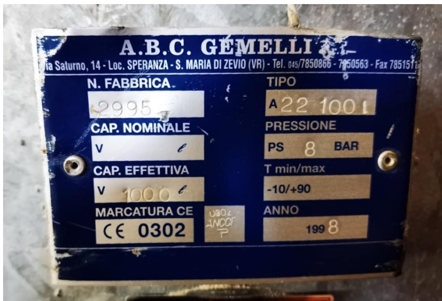
Slika 7. Natpisan pločica spremnika zraka
