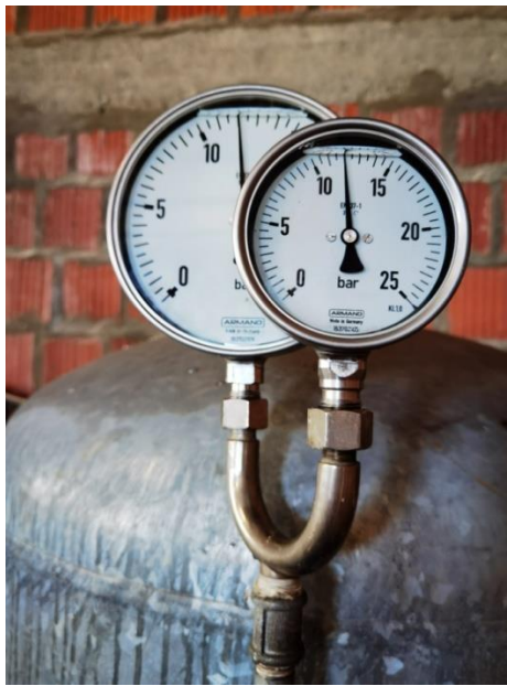
Slika 13. Ispitni manometri klase 1,0
