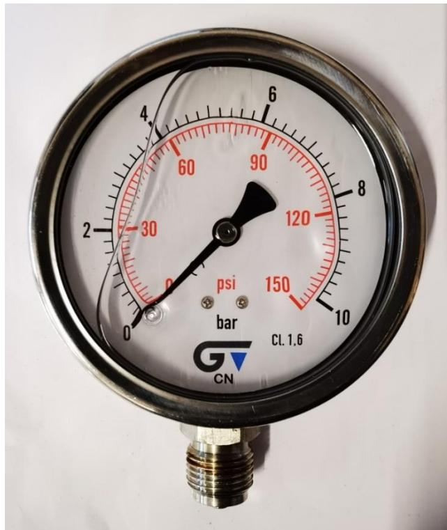
Slika 9. Kontrolna oprema – manometar
