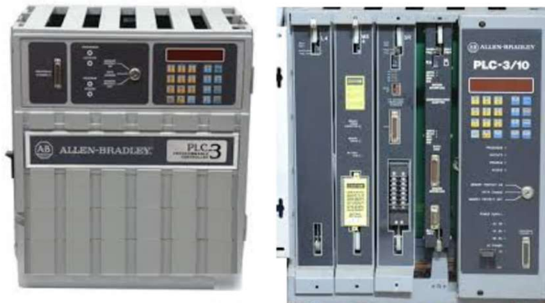
Slika 3. 1 Primjer prvog PLC-a Allen Bradley [5]
