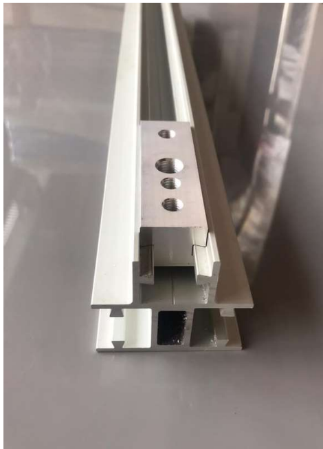
Slika 5. 1 Izgled korištenog eloksiranog aluminijskog profila
