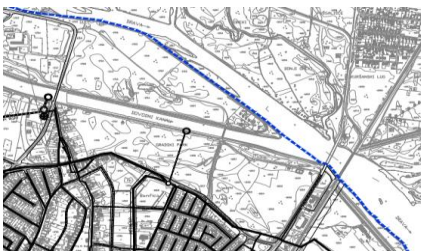
Slika 4.7 Prometna i komunalna infrastruktura - Vodnogospodarski sustav - odvodnja. 78
