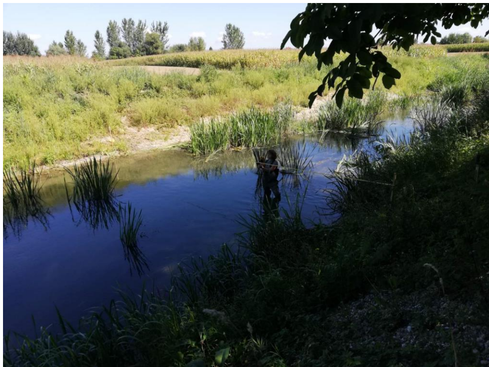
Slika 3.7. Prikaz trećeg hidrometrijskog mjerenja (03.09.2021.) u uvjetima iznimno niskog vodostaja i velike obraslosti korita [3]
