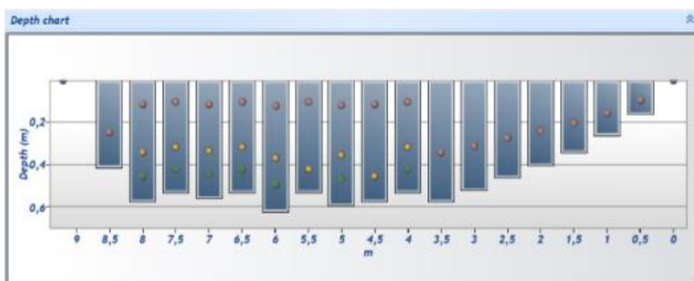
Slika 4.12. Dijagram dubine u koritu s trećeg mjerenja 03.09.2021.
