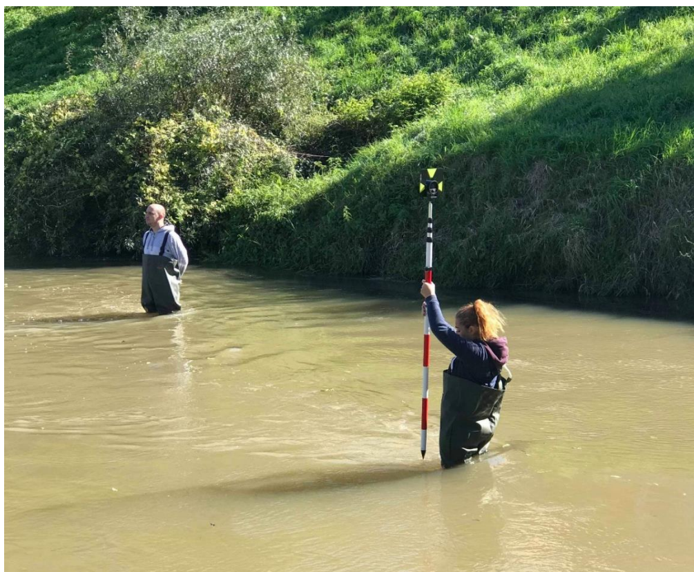
Slika 2.2. Geodetsko određivanje nagiba dna vodotoka [3]
