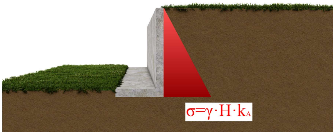
Slika 4 : Naprezanja uzrokovana aktivnim tlakom
