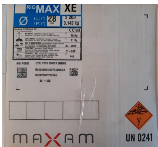
Slika 2. Označavanje vanjske ambalaže eksplozivne tvari
