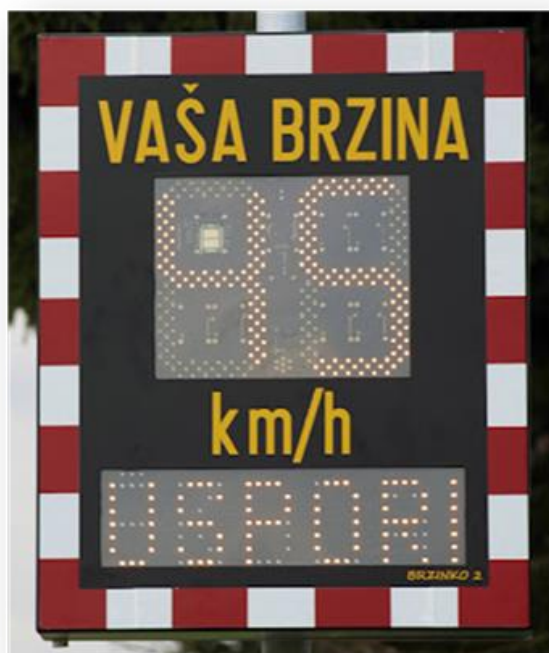
Slika 14. Preventivni radarski mjerač s pokazivačem brzine kretanja vozila
