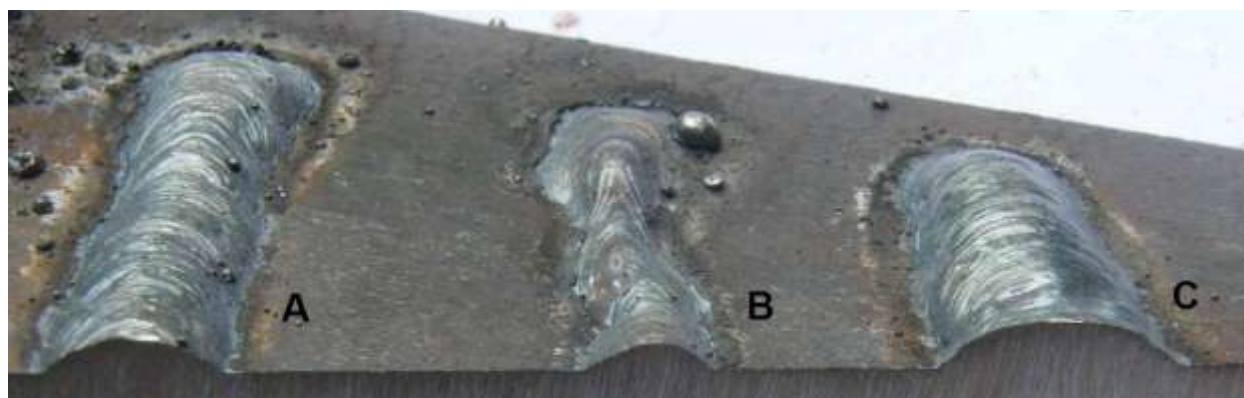
Slika 4.6 Uključci troske na površini zavarenog spoja
