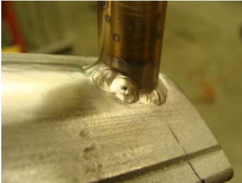
Slika 5.17 Površina zavarenog spoja gdje su vidljive tzv. "riblje oči" koje su rezultat vodika u zavaru [20]
