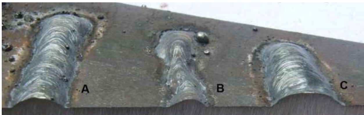
Slika 4.6 Uključci troske na površini zavarenog spoja
