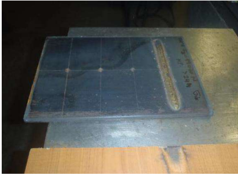
Slika 6.4 Prikaz navara na Implant ploči [17]
