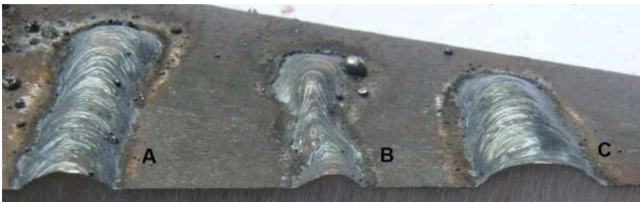
Slika 4.6 Uključci troske na površini zavarenog spoja
