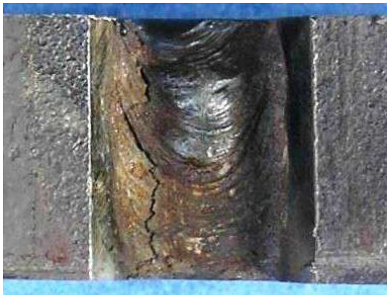
Slika 6.12 Lice zavara uzorka - primjer iz prakse [25]
