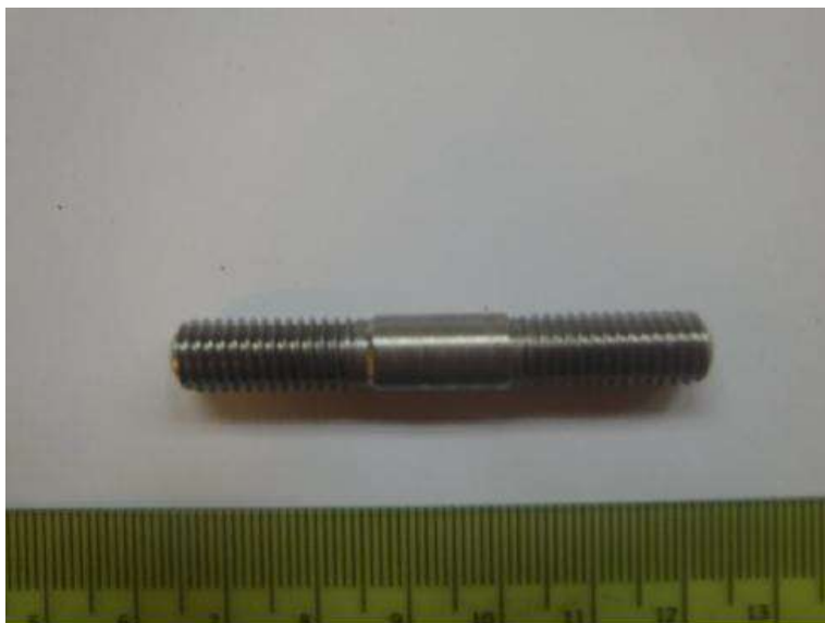
Slika 6.2 Implatni uzorak s obostranim navojem [17]
