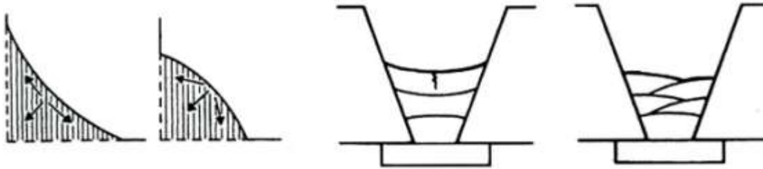
Slika 5.18 Zavar udubljenog oblika (veća sklonost pojavi pukotina) i zavar blago ispupčenog oblika radi većih naprezanja na površini [5]
