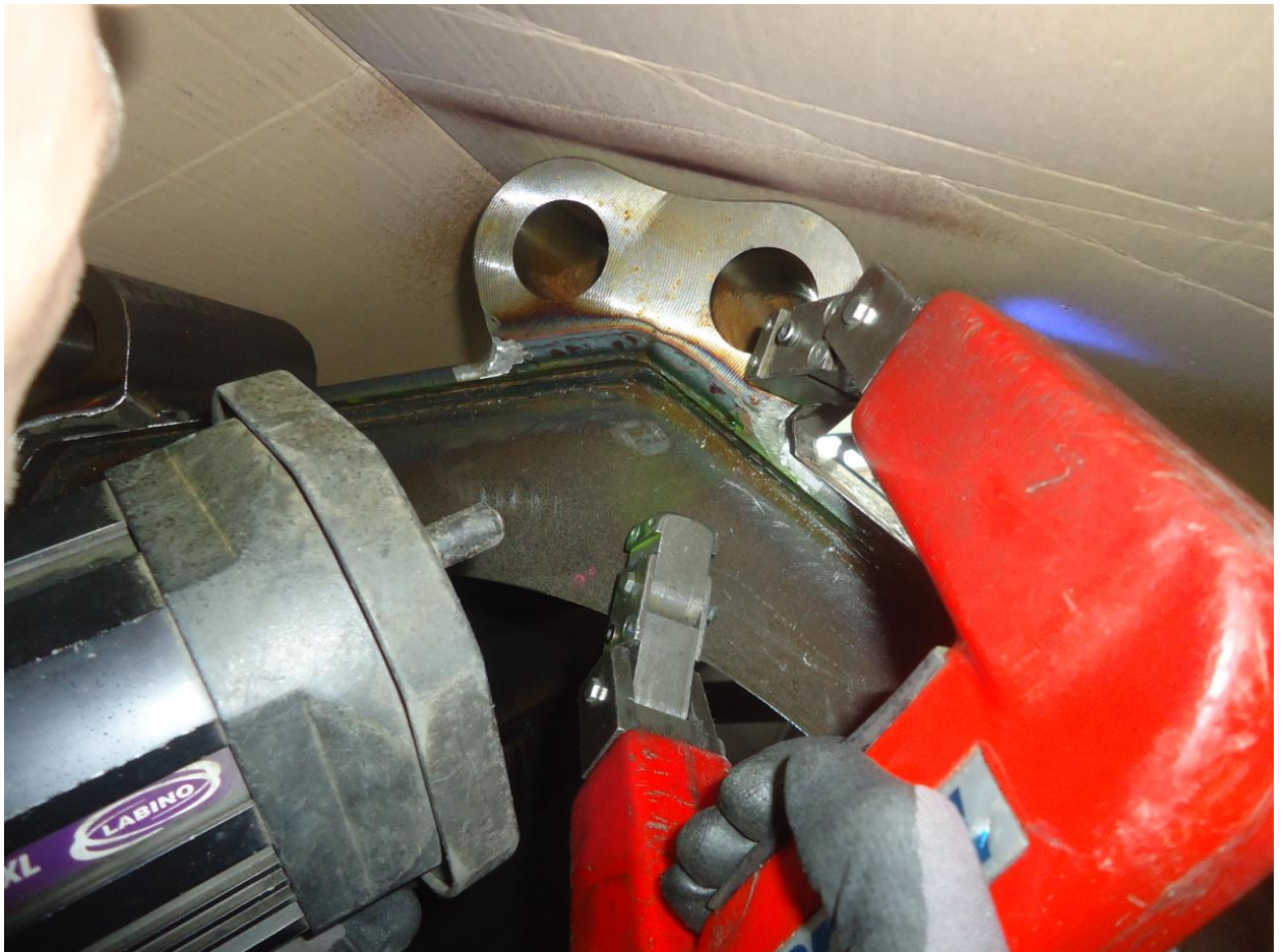
Slika 5.19 Ispitivanje magnetskom kontrolom
