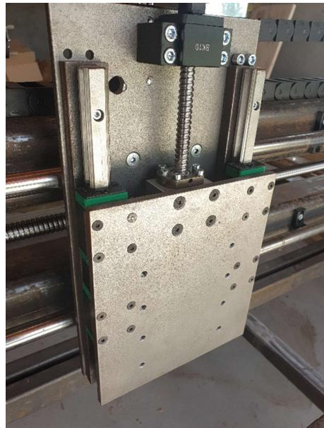
Slika 3.36 Postavljanje ploče za montiranje glodalice
