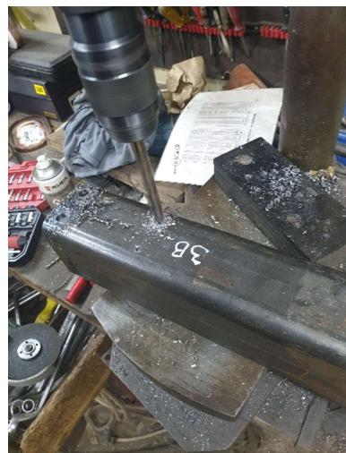
Slika 3.7 Bušenje provrta
