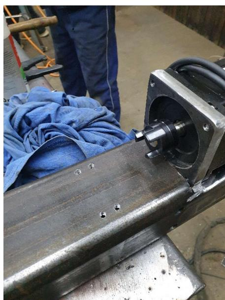
Slika 3.14 Provrt i navoj za montiranje BK15 i
