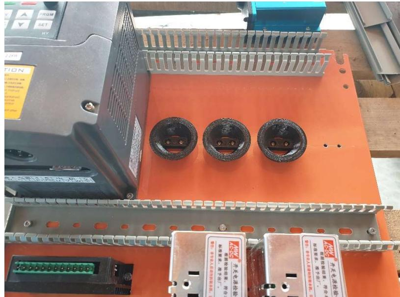
Slika 4.8 Postavljanje statickih dijelova konektora
