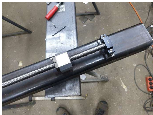
Slika 3.17 Namontirano kućište navojne matice
