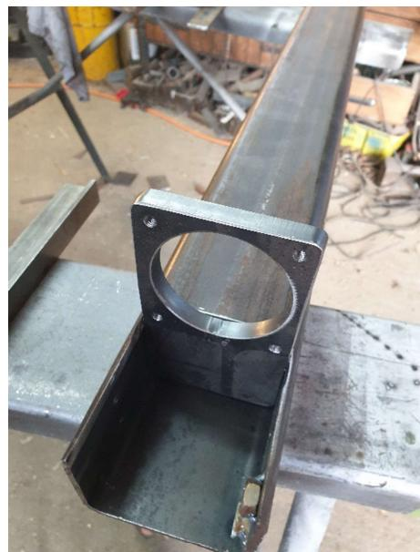
Slika 3.11 Spajanje nosača koračnog motora i Y osi
