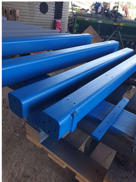
Slika 3.40 Premaz završnim slojem
