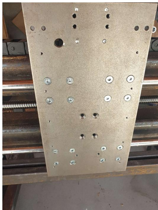
Slika 3.31 Montirana ploča na vodilice X osi
