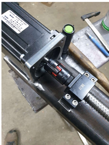
Slika 3.15 Montiranje blokova i navojne šipke
