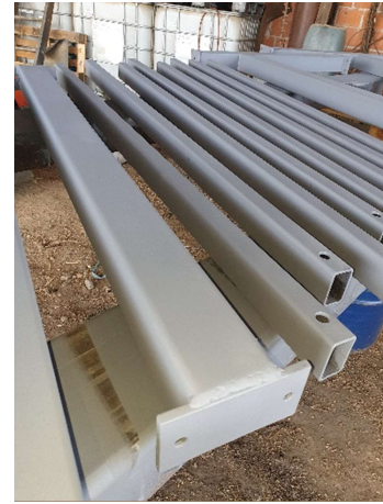
Slika 3.39 Premaz temeljnom bojom
