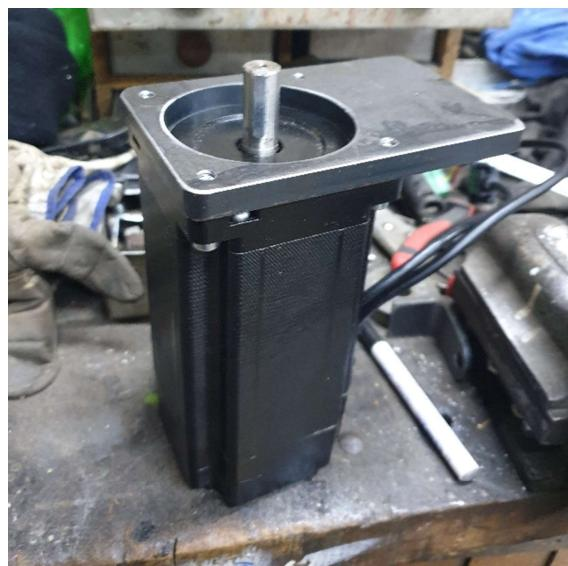
*Slika 3.1 Nosač koračnog motora*
