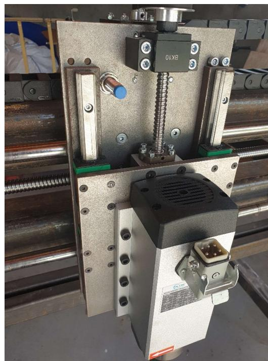
Slika 3.37 Završen sklop Z osi
