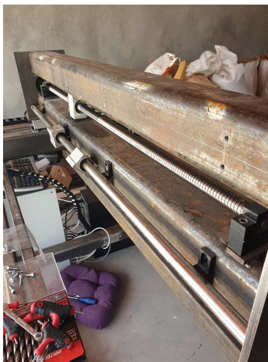
Slika 3.27 Postavljanje kuglične navojne šipke na X os
