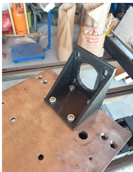
*Slika 3.29 Montiranje nosača motora Z osi*
