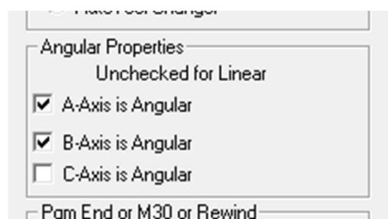
Slika 4.17 Postavljenje C osi u linearni način
