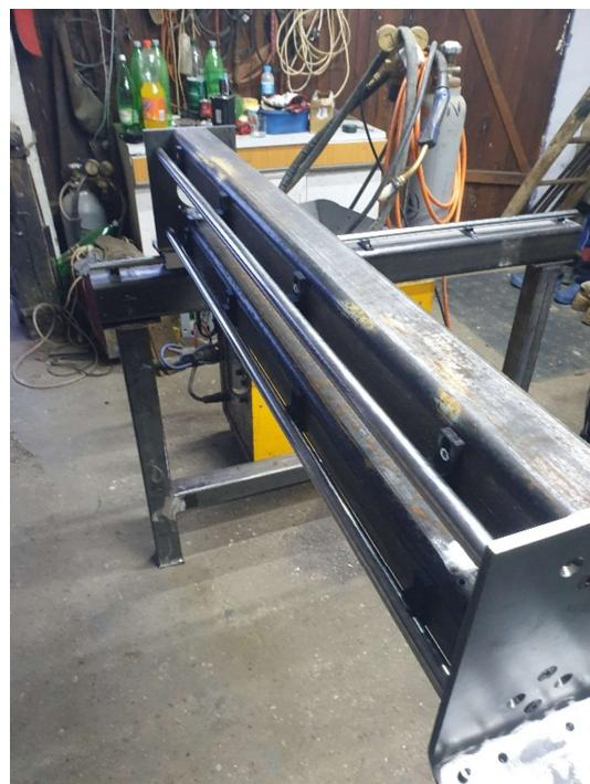
*Slika 3.25 Montirane vodilice X osi*
