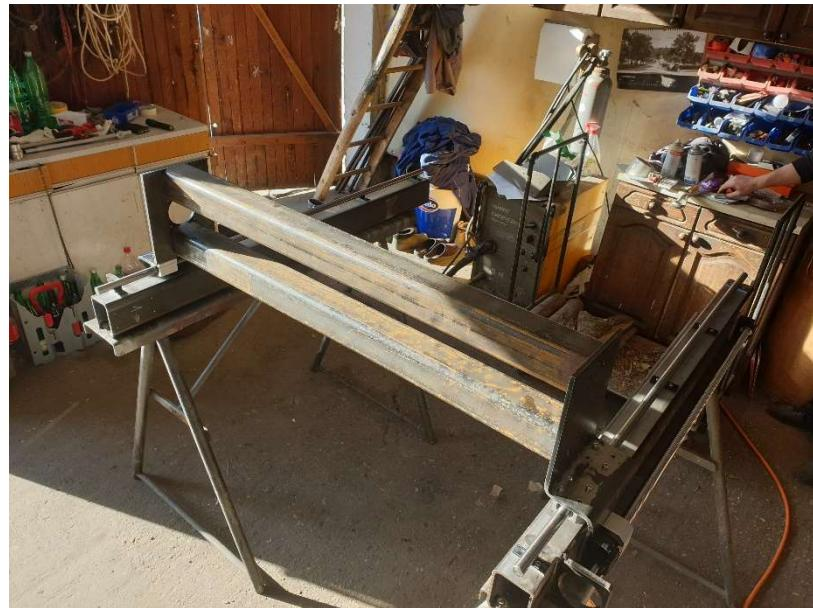
*Slika 3.24 Probna montaža X osi*
