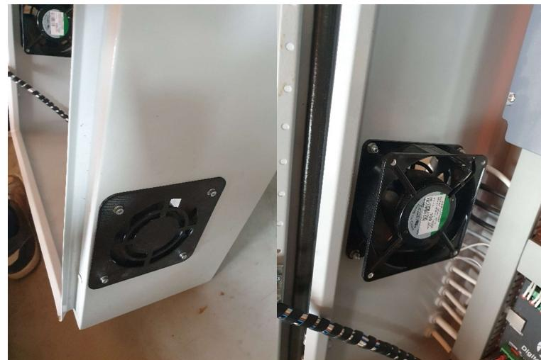
Slika 4.10 Montiranje ventilatora i zaštite
