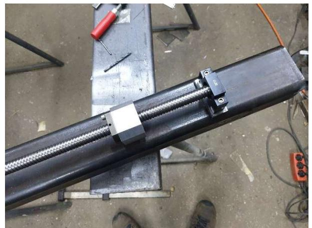
Slika 3.17 Namontirano kućište navojne matice
