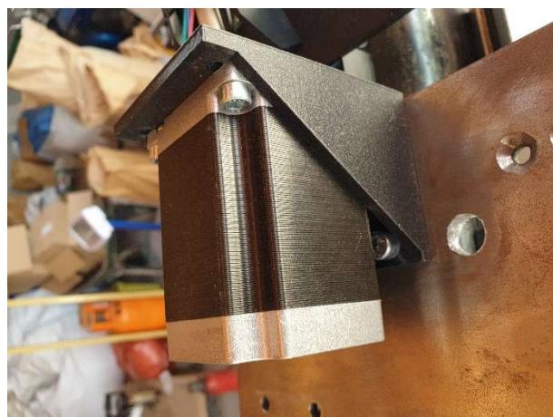
Slika 3.30 Montiranje motora Z osi
