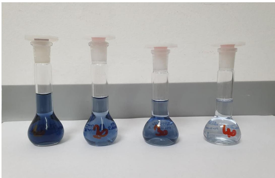
Slika 12. Pojava plavog obojenja kao posljedica oksidacije fenolnih spojeva
