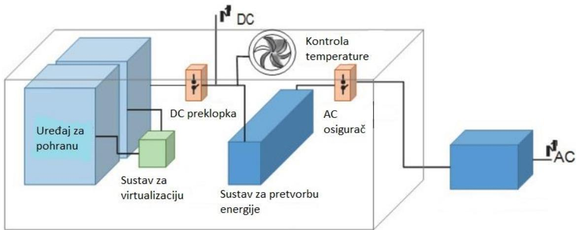
*Slika 4.3 Shematski prikaz baterijskog spremnika i primarni dijelovi [13]*
