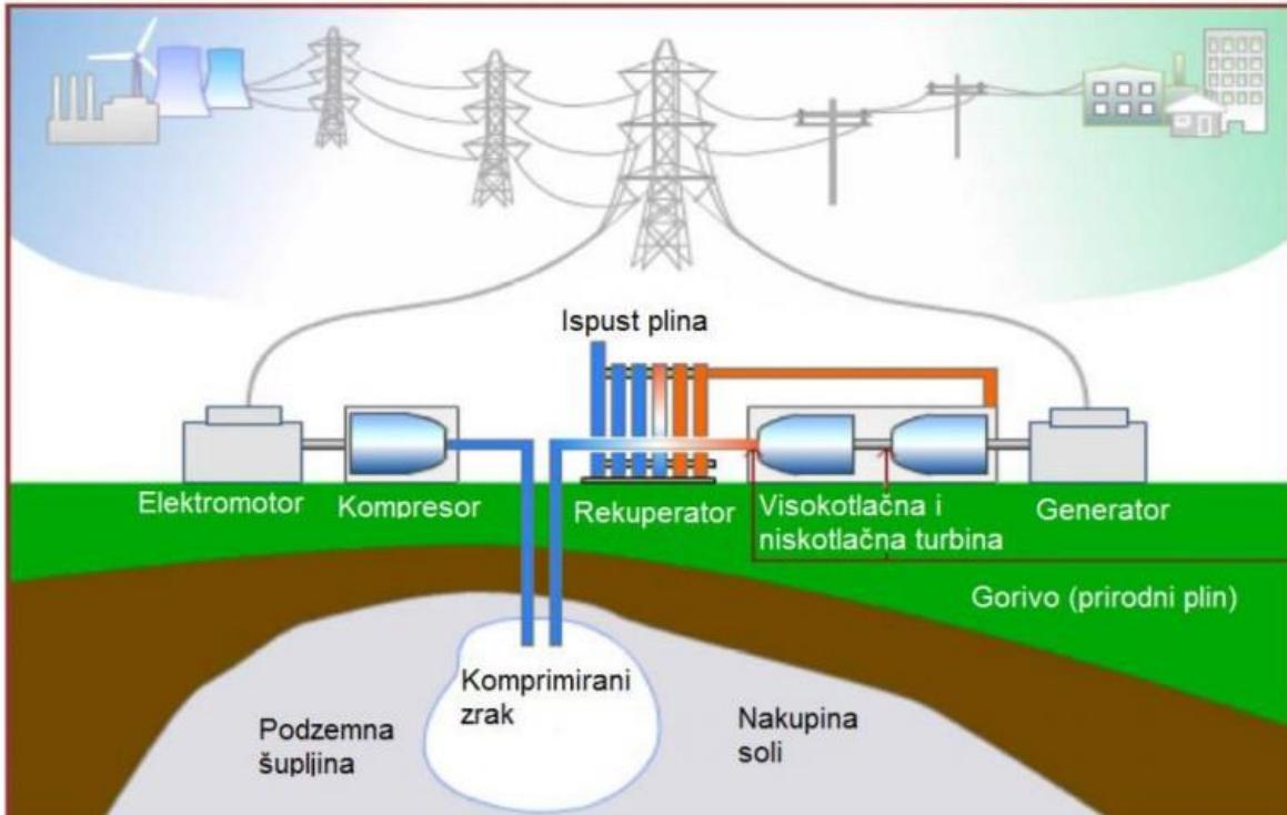
Slika 3.3 Shematski prikaz skladištenja energije komprimiranim zrakom [7]
