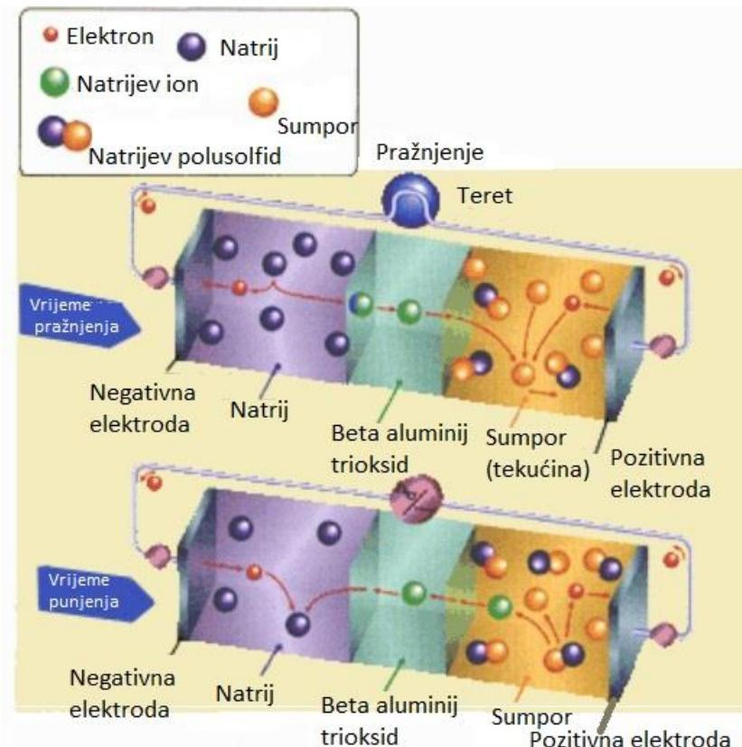
Slika 3.10 Shematski prikaz rada NaS baterije [1]
