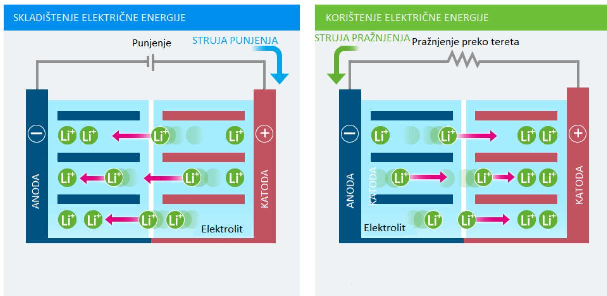
Slika 3.13 Princip rada Li - ion baterije [23]
