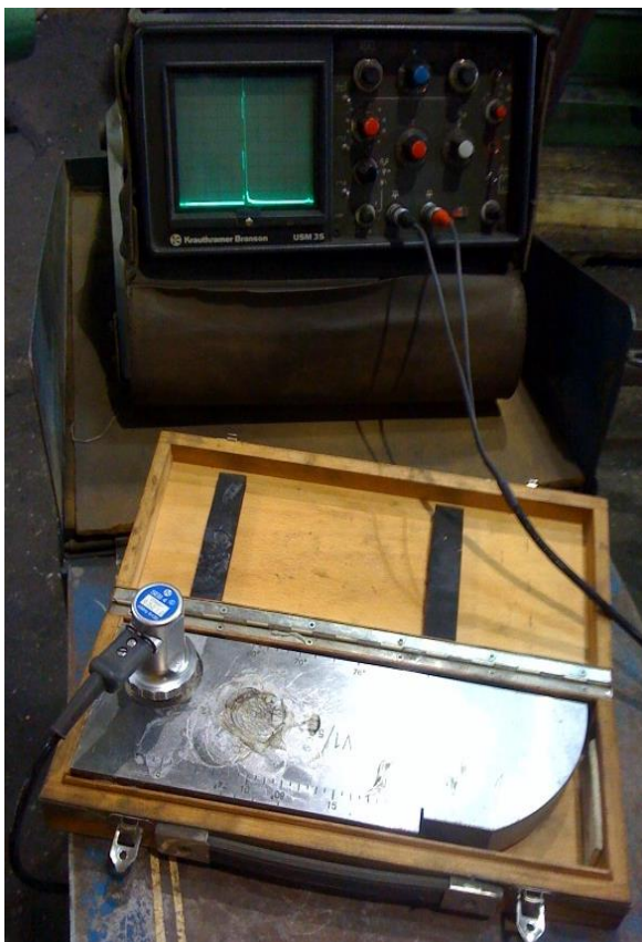
Slika 3.7 Baždarenje pomoću etalona
