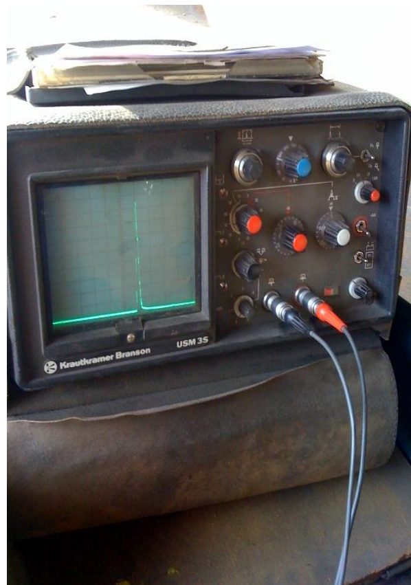
Slika 3.8 Uređaj za UZ kontrolu
