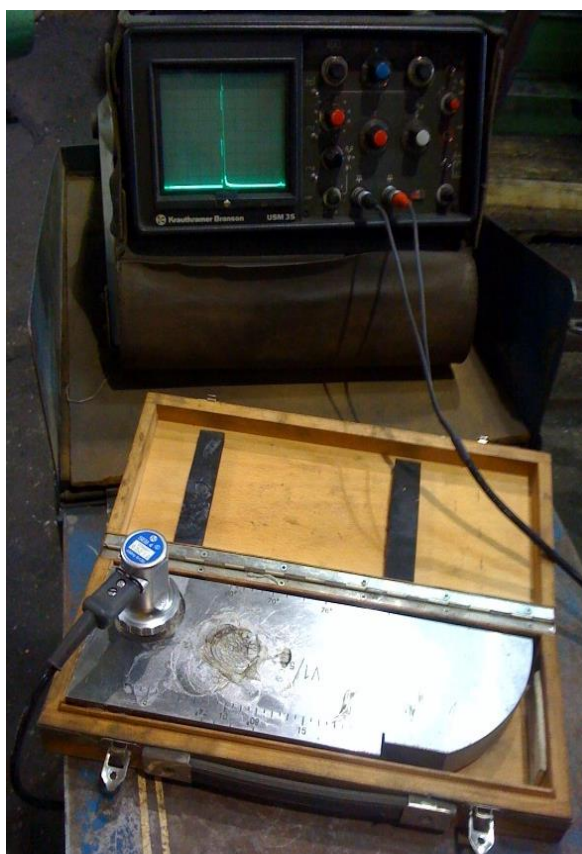
Slika 3.7 Baždarenje pomoću etalona
