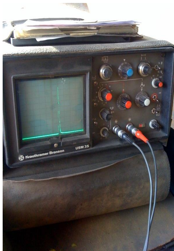
Slika 3.8 Uređaj za UZ kontrolu
