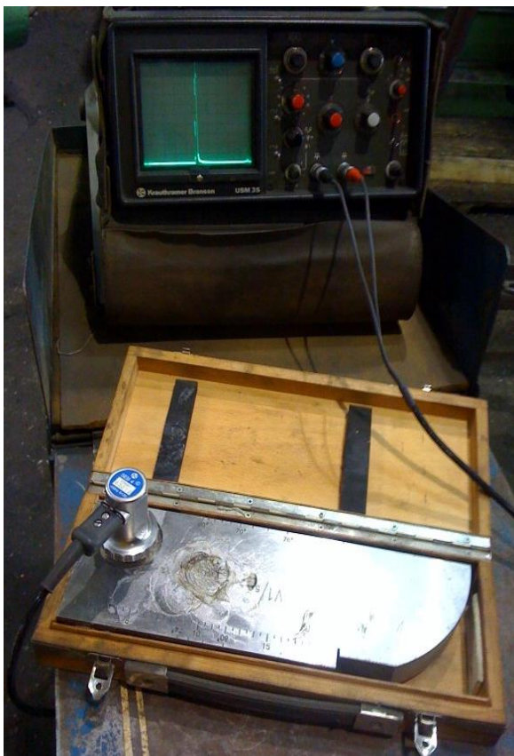
Slika 3.7 Baždarenje pomoću etalona
