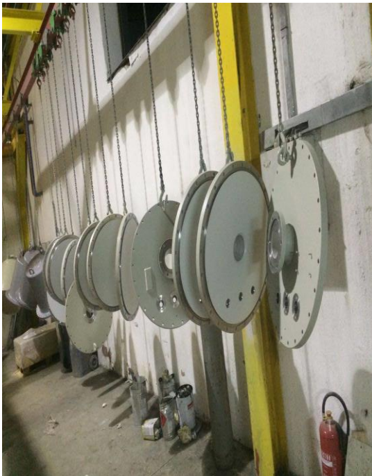
Slika 3.12 Poklopci nakon pjeskarenja
