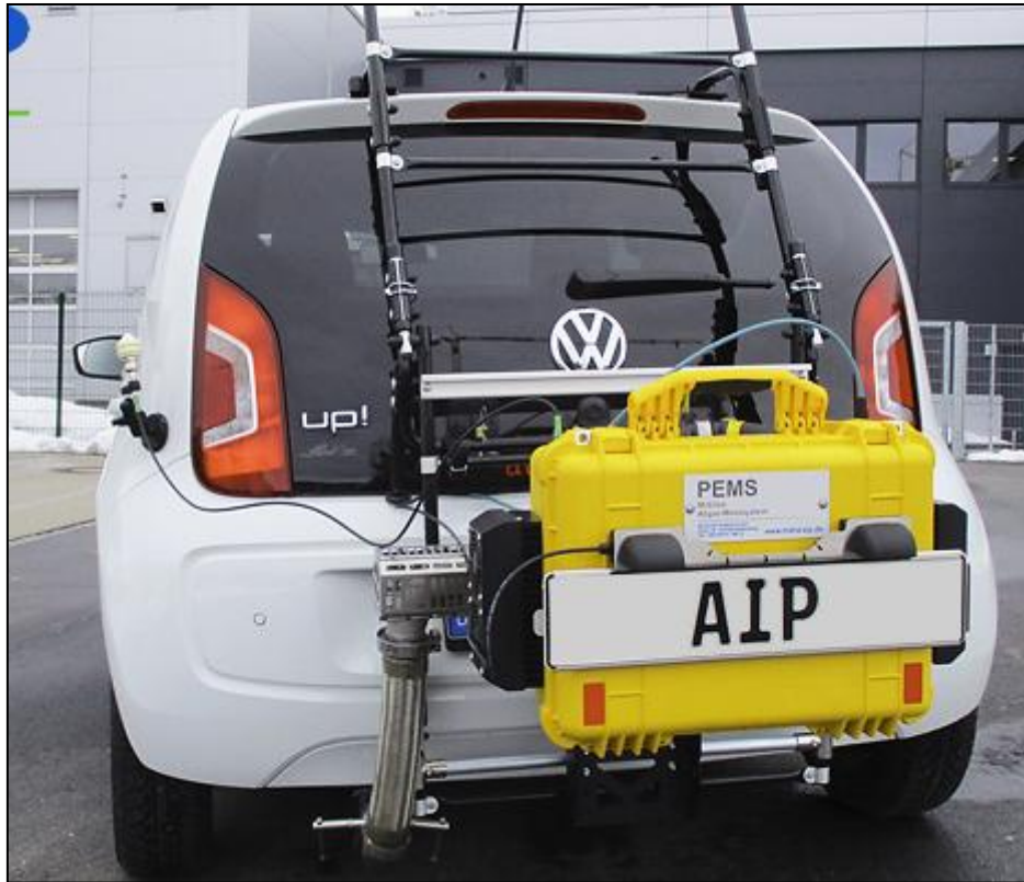
Slika 4.3.3. Izgled PEMS uređaja [32]
