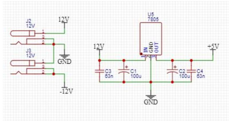
Slika 15. Shema sklopa kojim je realizirano napajanje 5V
