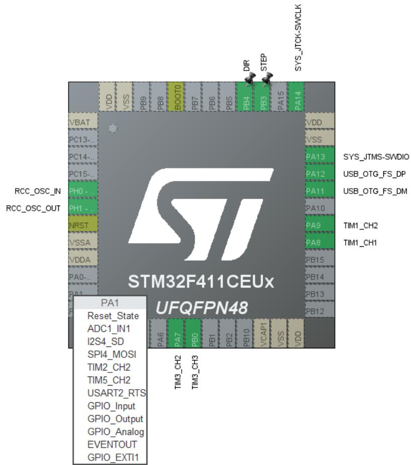
Slika 21. Odabir korištenih pinova unutar STM32CUBE IDE razvojnog okruženja
