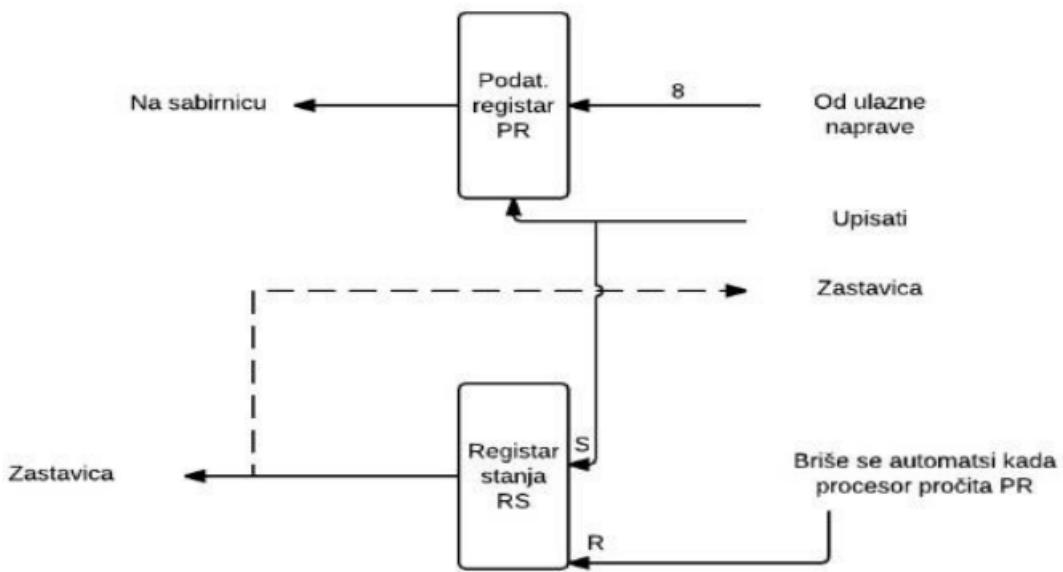
Slika 21: Shematski prikaz ulaza pojedinačnog znaka
