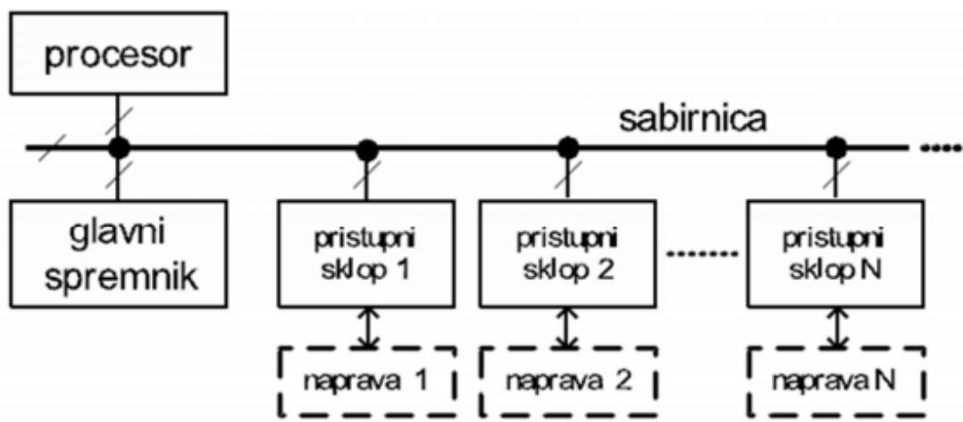
Slika 19: Prikaz spajanja ulazno-izlaznih naprava na sabirnicu računala
