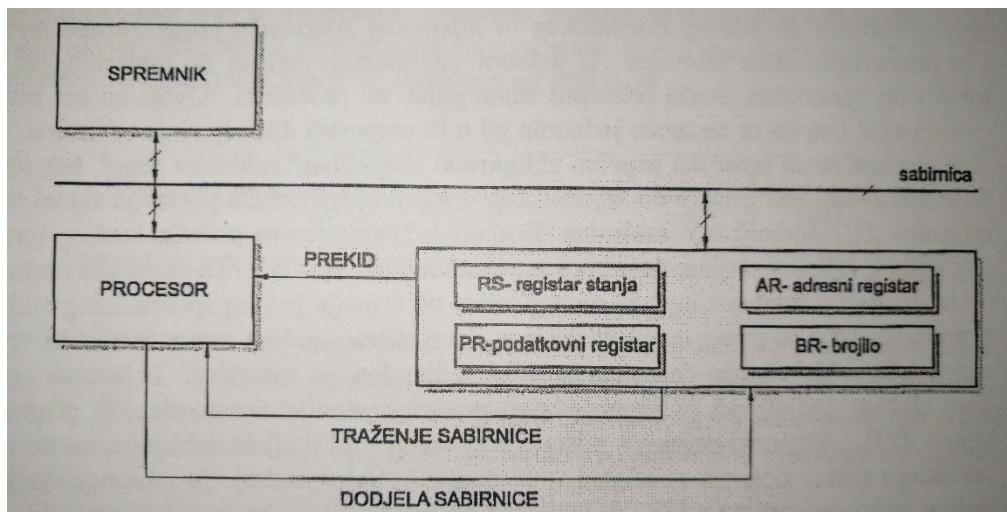
Slika 23: Shema jednostavnog modela za neposredni pristup spremniku
