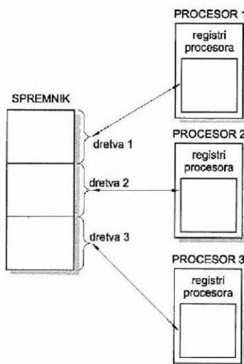
Slika 18: Prikaz višedretvenog rada na višeprocesorskom računalu
