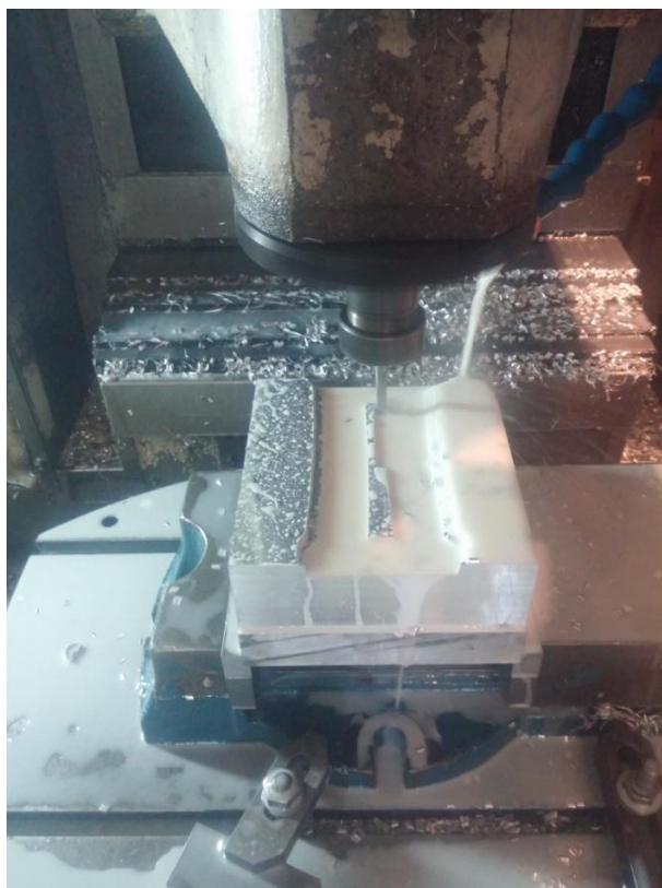
Slika 5.2.11 Grubo glodanje na stroju [2]
