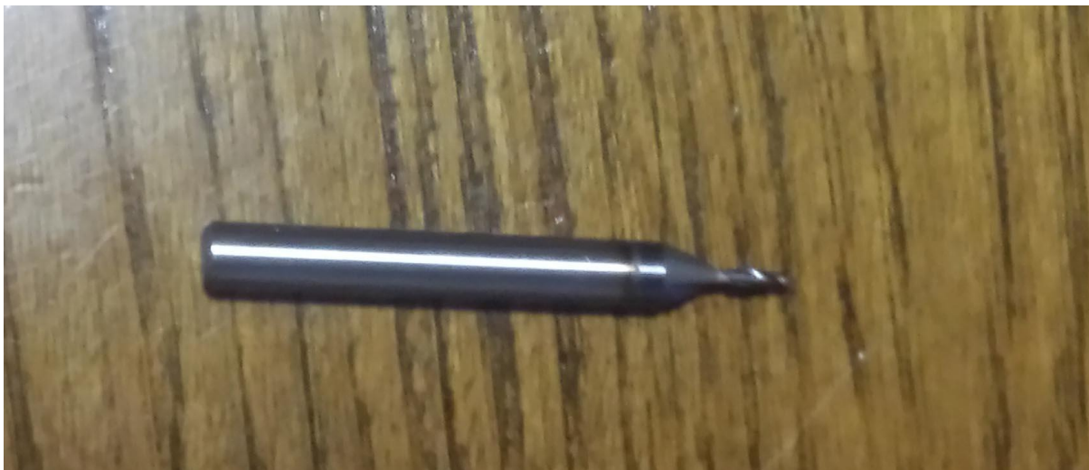
Slika 4.4.5 Glodalo za kanal D2 [2]
