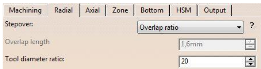
Slika 5.2.6 Preklapanje alata pri glodanju [3]
