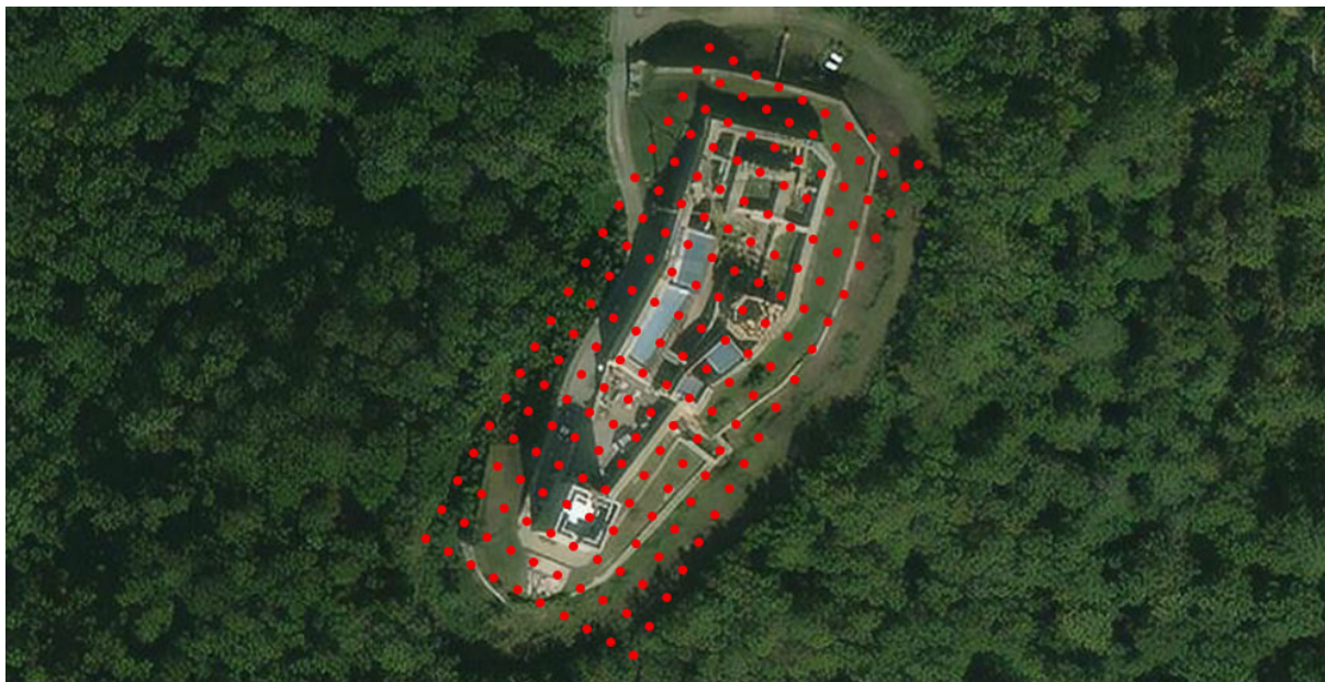
Slika 5.25 Prikaz pozicija slikanja za 90% preklapanje
