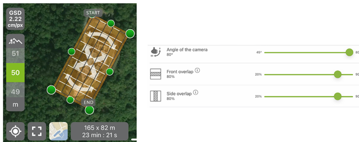
Slika 5.12 Mrežasto snimanje sa 80% preklapanja
