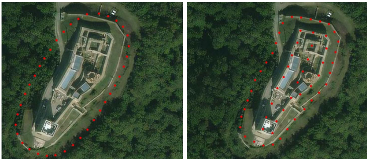
Slika 5.32 Kružni (lijevo ) i hibridni (desno) plan leta
