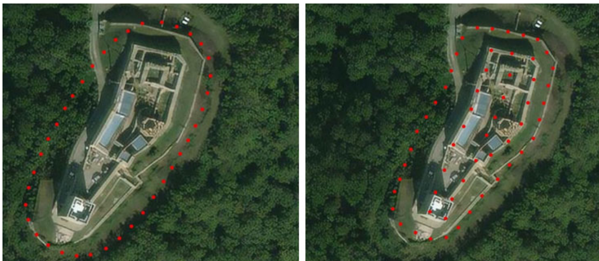
Slika 5.32 Kružni (lijevo ) i hibridni (desno) plan leta
