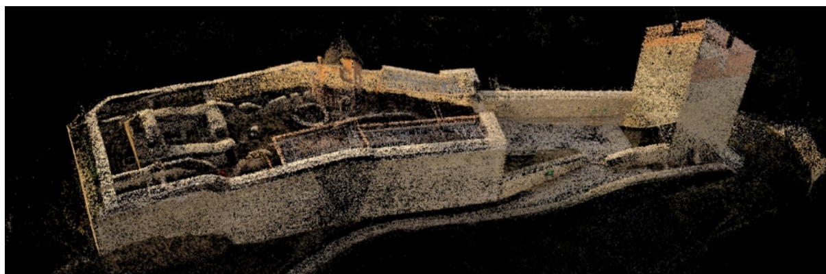
Slika 5.33 Točkasti oblak proizveden kružnim planom leta
