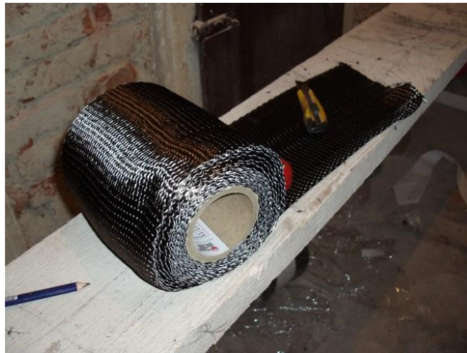
Slika 5.21 Ugrađivana karbonska traka
