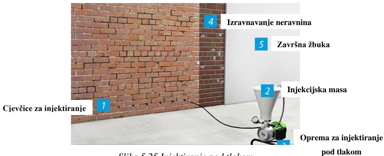
Slika 5.25 Injektiranje pod tlakom
